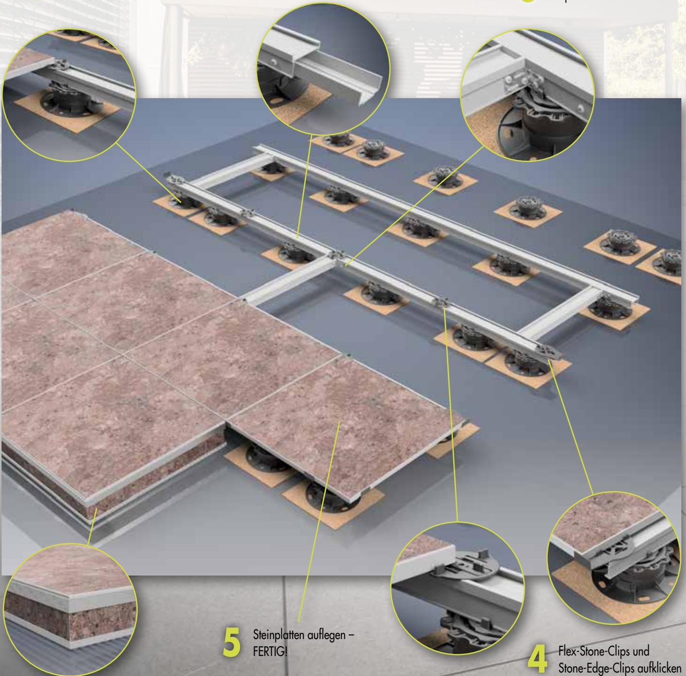
**5** Steinplatten auflegen – FERTIG!
