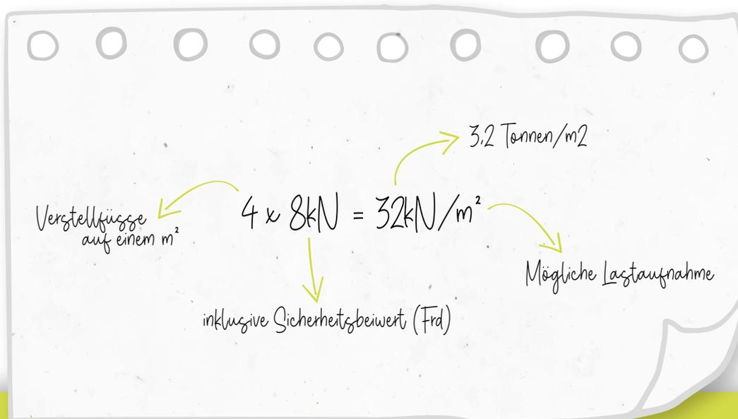
Dies entspricht einer möglichen Lastaufnahme von  $32 \text{ kN/m}^2$  oder  $3,2 \text{ Tonnen/m}^2$ .
