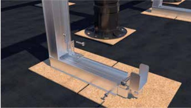
**2** Zwei **EVO Profile** auf Gehrung schneiden. Anschließend Profile verbinden und mit **Eckverbinder** befestigen. Bohrung und Langloch verwenden. → Ausdehnungskoeffizient Aluminium
