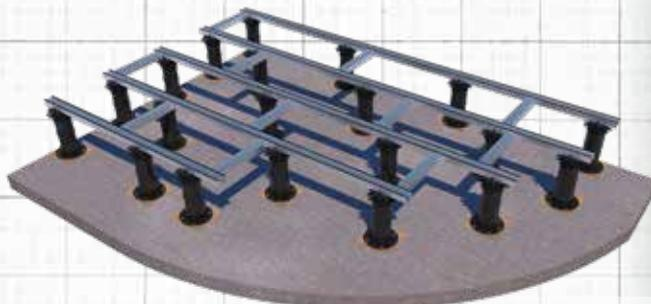
**3** Vorgefertigte Seitenelemente positionieren.
