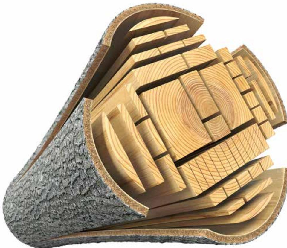
Möglicher Einschnitt eines Baumstammes
