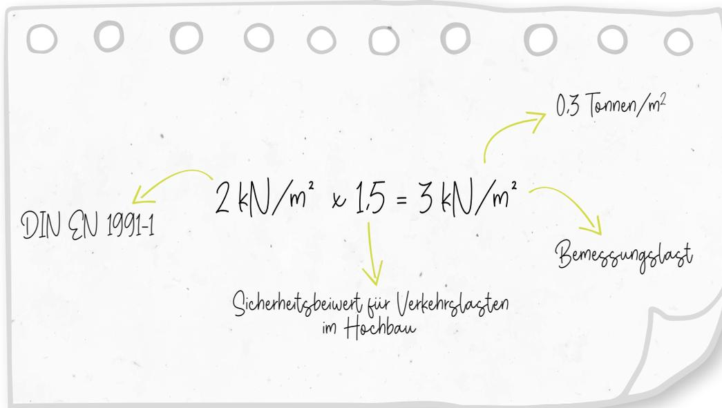
Der Wert von  $3 \text{ kN/m}^2$  kann nun mit der Tragfähigkeit der Verstellfüße verglichen werden. Wenn die Tragfähigkeit der Verstellfüße größer ist, als diese vergleichbare Belastung, sollten die Verstellfüße in der Lage sein, die gegebene Nutzlast zu tragen.
