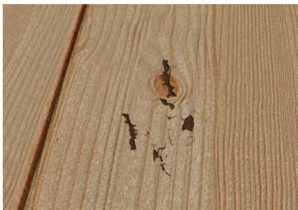
*Schilfer/Ablösung der Jahringe bei Nadelhölzern; darüber trockenbedingter Riss im gesunden Ast*
