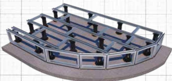
**4** Seitenelemente mit dem **Scharnierverbinder EVO** untereinander verbinden und mit Hilfe des **Alu-Betonwinkels** am Boden befestigen.
