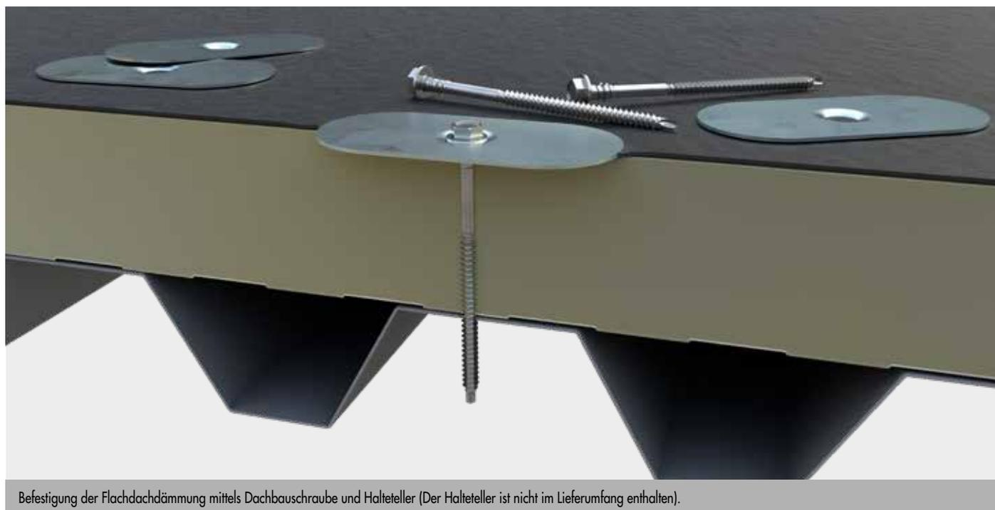
Befestigung der Flachdachdämmung mittels Dachbauschraube und Halteteller (Der Halteteller ist nicht im Lieferumfang enthalten).
