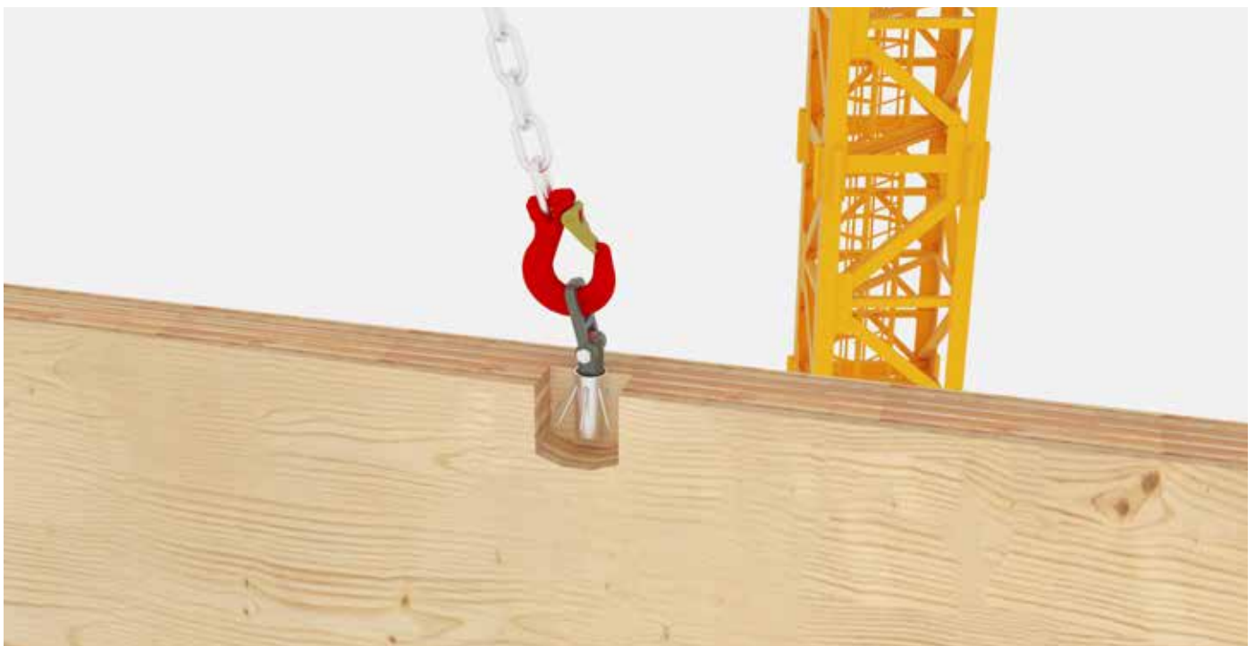
Anwendung HebeFix zum Transport einer Wand
