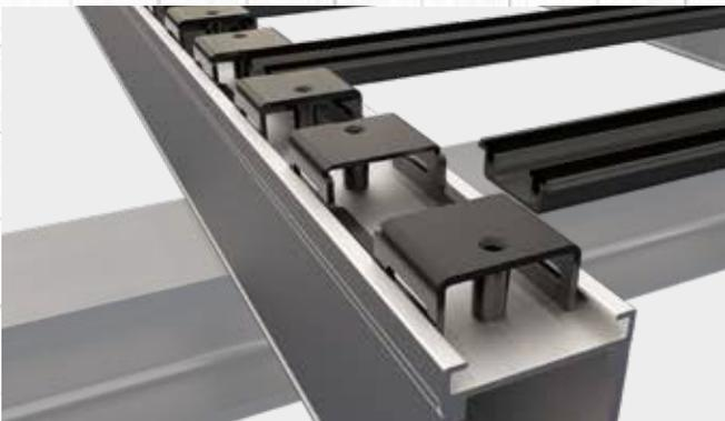
**4** Dielen auflegen, die Schienen mittig in die Fuge verschieben und die Dielen durch die EVOdry Halter durchschrauben. Bei einer Diele mit einer Höhe von 25 mm diese mit einer Profilbohrschraube (Länge 61 mm) befestigen.
