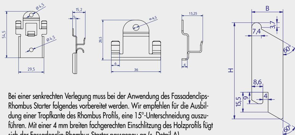
Bei einer senkrechten Verlegung muss bei der Anwendung des Fassadenclips-Rhombus Starter folgendes vorbereitet werden. Wir empfehlen für die Ausbildung einer Tropfkante des Rhombus Profils, eine 15°-Unterschnidung auszuführen. Mit einer 4 mm breiten fachgerechten Einschlitzung des Holzprofils fügen sich der Fassadenclip-Rhombus Starter passgenau an (s. Detail A).
