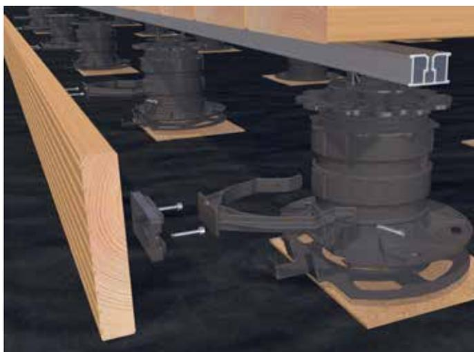
Befestigung einer Holzblende mithilfe des Blendhalters.
