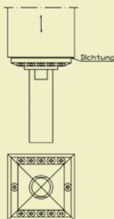
Der Stützenfuß PediX kann einfach am Hirnholzschnitt angebracht werden: Die Dichtung auf den Stützenfuß legen und beide Teile zentrisch auf der Hirnholzfläche platzieren. Hinweis: Zur leichteren Montage können Fußplatte und Abdekhülse abgeschraubt werden.
