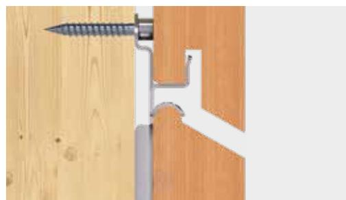
Wandanschluss mit Fassadenclip-Rhombus
