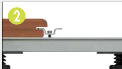
Weitere Diele einführen mit einer ca. 7mm Fuge (gemessen an der Oberkante) vorbereiten.
