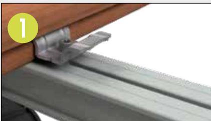
V-Clip in Position bringen und mit der 4,2 x 25 mm Schraube leicht fixieren.
