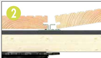
Befestigung des Holzes im Terrassenclip R14, sodass beide Zähne an der Aufreißung des Brettes liegen.
