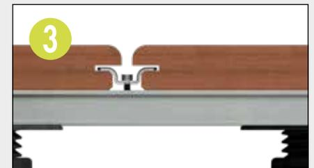
Weitere V-Clips einlegen und wieder leicht fixieren, dahinterliegende V-Clips können nun angezogen werden. Achten Sie hier auf die richtige Einstellung des Drehmoments!
