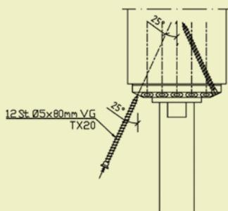
Nach der Zentrierung der Kopfplatte können die mitgelieferten 12 A2 Vollgewindeschrauben 5,0 x 80 mm in einem Winkel von 25° ohne Vorbohren montiert werden.
