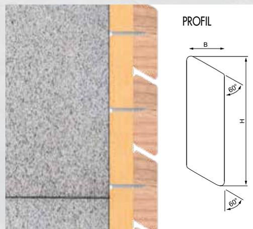
Wandanschluss mit Fassadenschraube ZK
