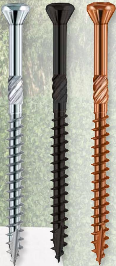
Bei der Hapatec-Schraube aus gehärtetem Edelstahl handelt es sich um einen Paneelbefestiger, speziell für Hartholz. Die Schraube verfügt über eine Schabennut an der Schraubenspitze, Fräsrippen über dem Gewinde und einen Zierkopf. Die Hapatec ist auch in antik und schwarz verfügbar.
