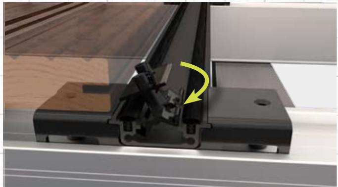
**5** Die EVOdry Schiene mit den EVOdry Clips in die Diele einschieben und mit einer Profilbohrschraube (Länge 41 mm) befestigen.
