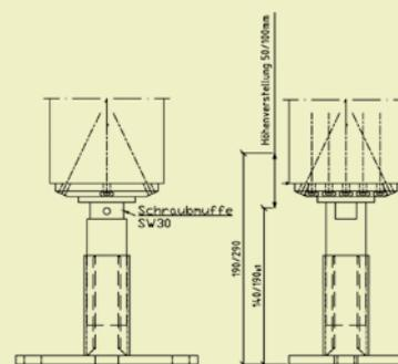
Die Schutzhülse und die Fußplatte können nach der Montage aller Schrauben wieder montiert werden. Nach dem Aufrichten der Stütze mit dem montierten Stützenfuß kann dieser auf einem Betonfundament mit 2 oder 4 Dübelankern oder Betonschrauben verankert werden. Mit einem Maulschlüssel SW30 kann der Fuß im eingebauten Zustand an der Muffe in der Höhe verstellt werden.
