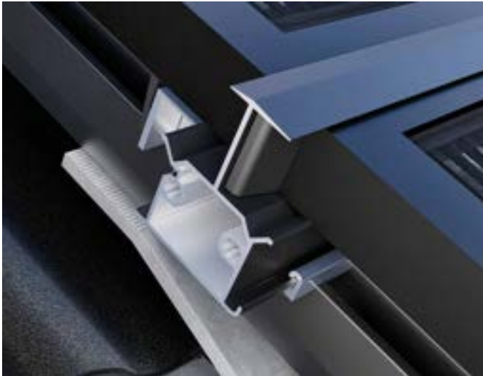
SCHRITT 18: Für den Rand brechen Sie den Stift am Abstandshalter an den Sollbruchstellen ab und klemmen diesen, wie in Schritt 17 hinter das Modul.
