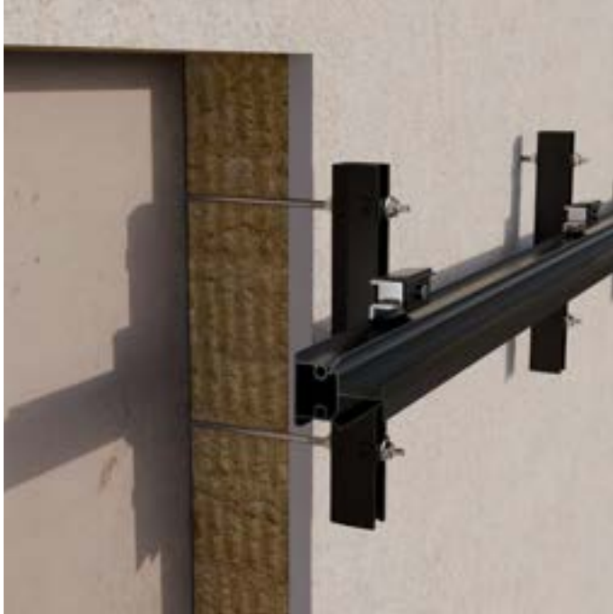
ALTERNATIVE ZU SCHRITT 3: EiSYS-P A4 in den Dübel einschrauben. Anschließend Sperrzahnmutter auf das M8-Gewinde aufschrauben. Basisprofil ausrichten und mithilfe von Fassadenbefestigung +Sperrzahnmutter arretieren.
