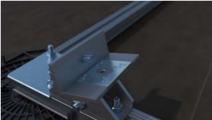
Der Potentialausgleichsclip wird auf die Modulauflaständerung hinten aufgesetzt und durch die Modulklemme fixiert.
