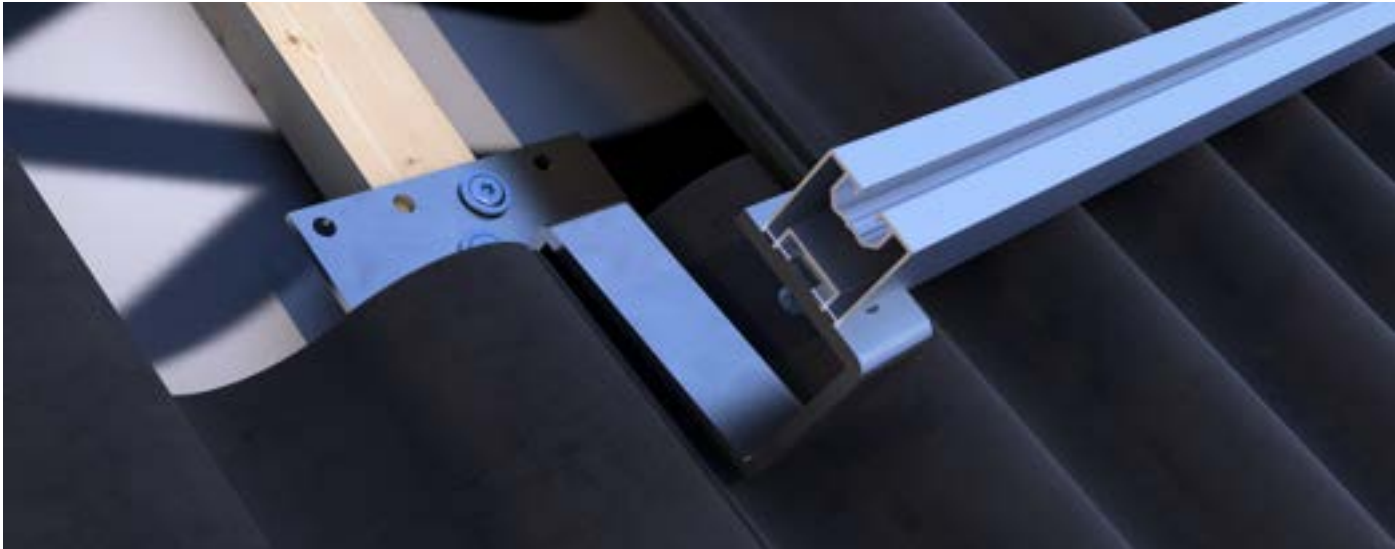
Dachhaken HEAVY an der Konterlatte montiert, durch die ausgeklinkte Dachpfanne geführt und mit montiertem Montageprofil Steildach.
