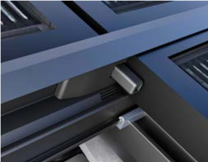
SCHRITT 17: Zwischen jedem Solarmodul wird in der oberen Einlegeschiene ein Abstandshalter LayTec eingesetzt. Dieser stellt automatisch einen Abstand von 10 mm zwischen den Solarmodulen her und sorgt dafür, dass sie nicht nach oben herausrutschen können.
