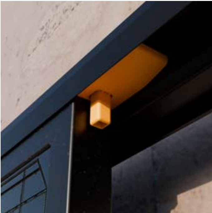
SCHRITT 11: Zwischen jedem Solarmodul wird in der oberen Einlegeschiene ein Abstandshalter LayTec eingesetzt. Dieser stellt automatisch einen Abstand von 10 mm zwischen den Solarmodulen her und sorgt dafür, dass sie nicht nach oben herausrutschen können. (Die Orangene Farbe ist nur zur besseren Darstellung. Der Abstandshalter ist schwarz)
