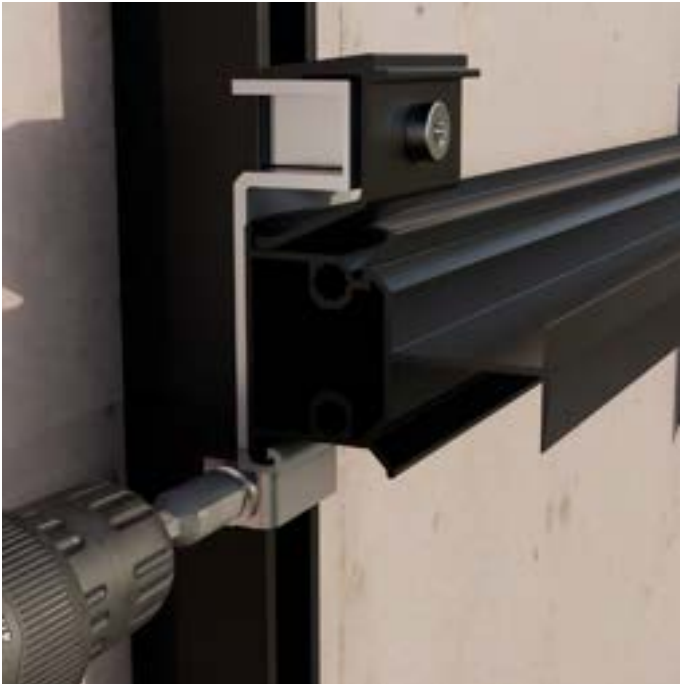
SCHRITT 8: Fassadensicherung unterhalb des Profilverbinders anlegen und mit Bighty-Schraube an das Basisprofil befestigen.
