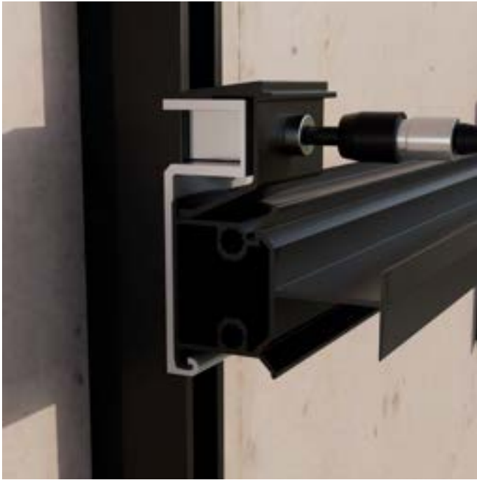
SCHRITT 7: Einlegeprofil ausrichten (vertikaler Abstand zwischen den Einlegeprofilen: Modullhöhe +8mm) und anschließend alles mithilfe der Schraube des Profilverbinders arretieren.
