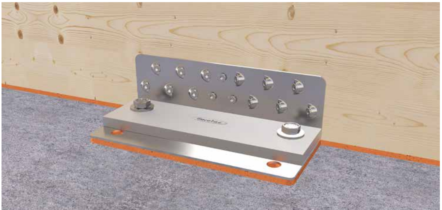
Cornière de cisaillement HB plate avec plaque de pression pour fixer une paroi sur les fondations en béton.
