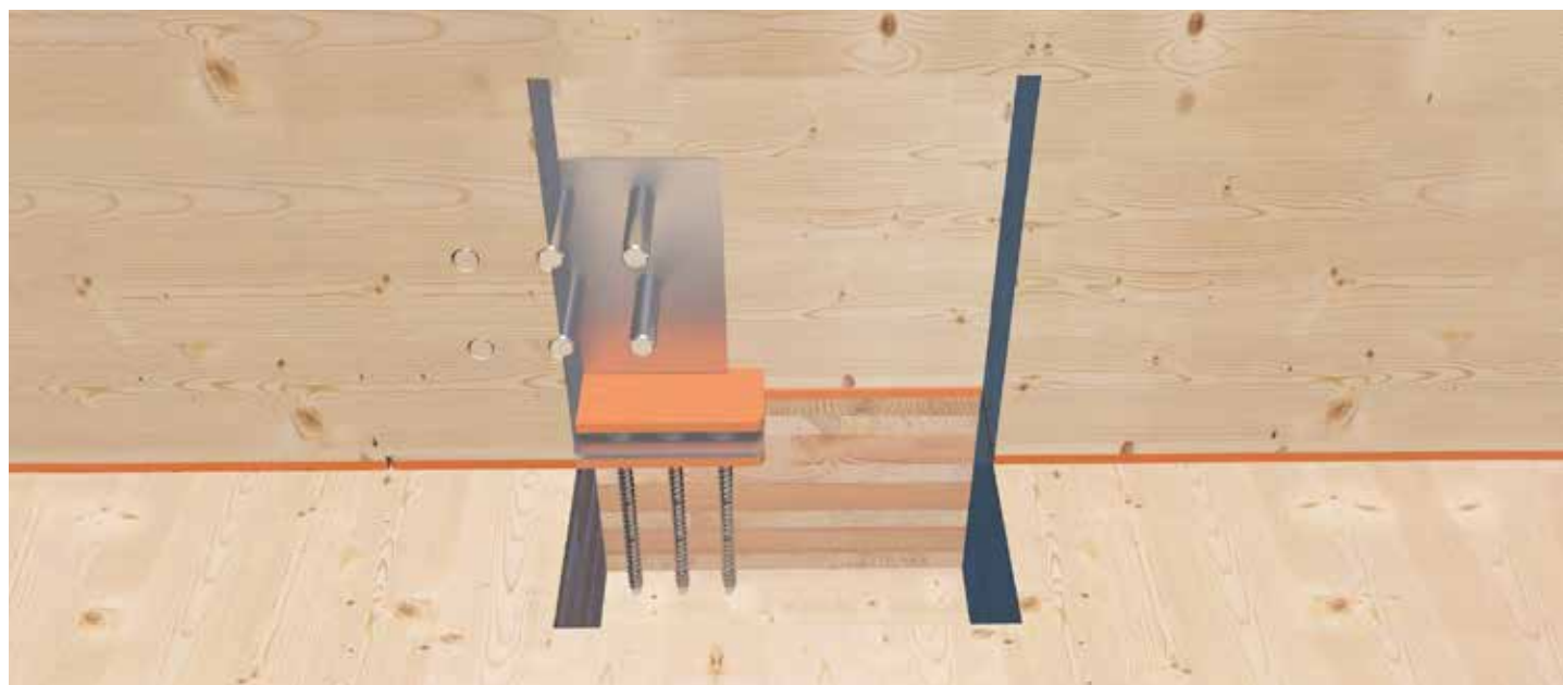
Ancrage de sol masqué pour la fixation invisible d'une paroi sur plancher.
