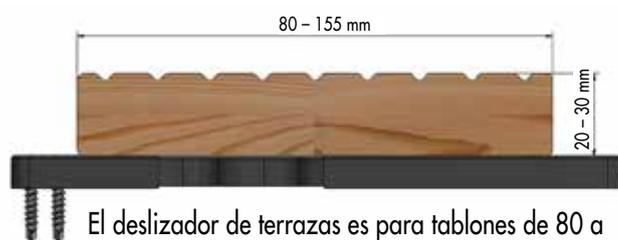
El deslizador de terrazas es para tablonces de 80 a 155 mm y un grosor de 20 - 30 mm.
