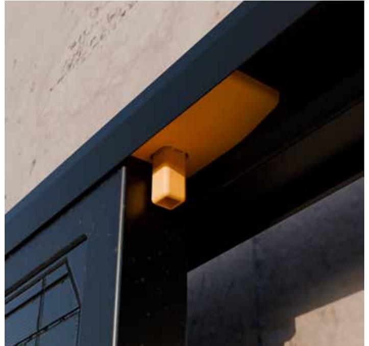
**SCHRITT 11:** Zwischen jedem Solarmodul wird in der oberen Einlegeschiene ein Abstandshalter LayTec eingesetzt. Dieser stellt automatisch einen Abstand von 10 mm zwischen den Solarmodulen her und verhindert ein Herausrutschen der Module nach oben. (Hinweis: Die orange Farbe dient lediglich der Darstellung; der Abstandshalter ist in der Ausführung schwarz.)
