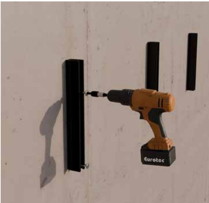
**SCHRITT 3:** Basisprofil ausrichten und mithilfe von Panelwistec Tellerkopfschraube A2 befestigen. Bei Fassaden mit Dämmung alternativ EiSYS Schraube verwenden (siehe optionale Schritte am Ende der Anleitung).
