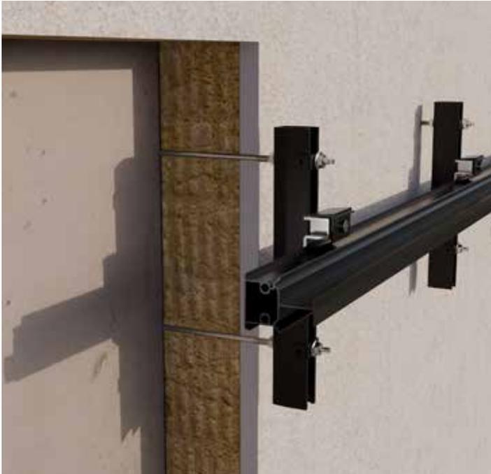
**ALTERNATIVE ZU SCHRITT 3:** EiSYS-P A4 Fassadenschraube in den Dübel einschrauben. Anschließend Sperrzahnmutter auf das M8 Gewinde aufschrauben. Basisprofil ausrichten und mithilfe von Fassadenbefestigung sowie Sperrzahnmutter arretieren.
