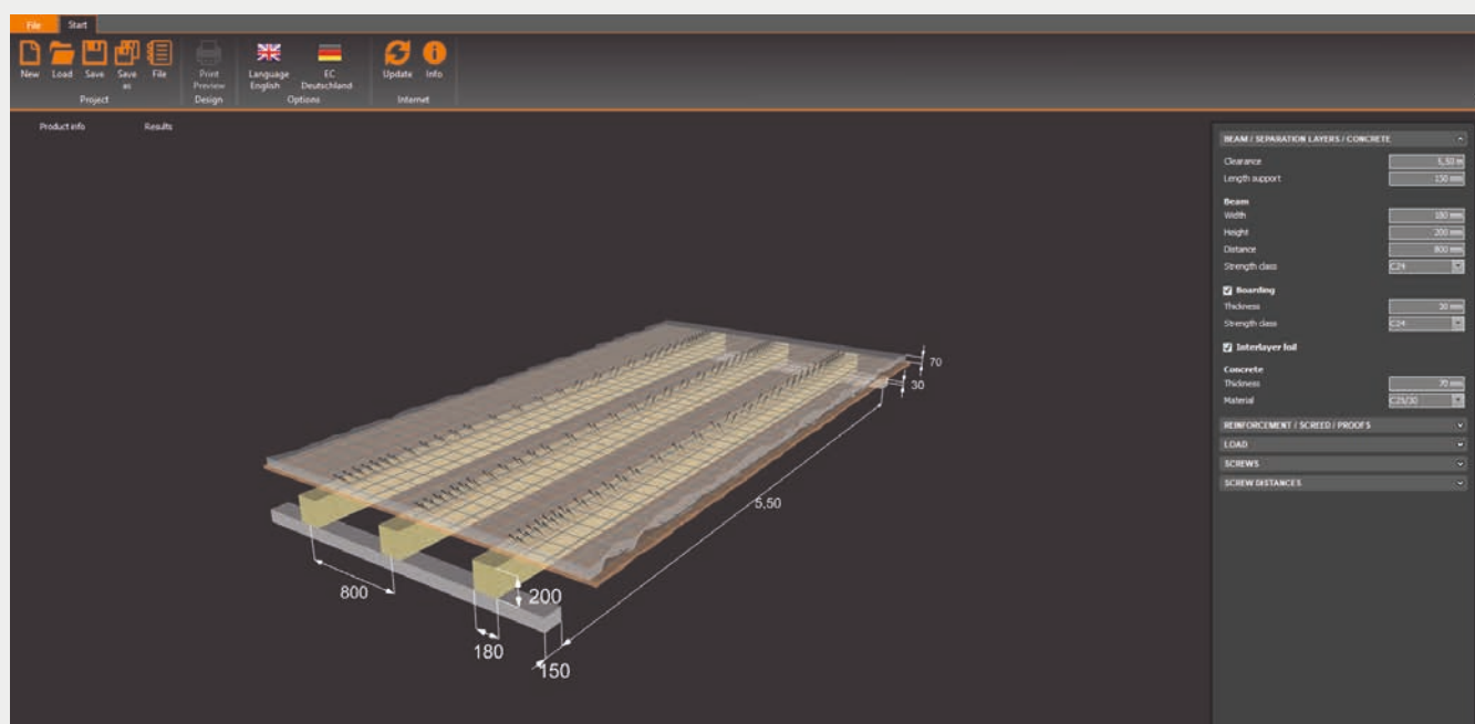
Interfaz del usuario del software ECS - Módulo Timber-concrete connector T II
