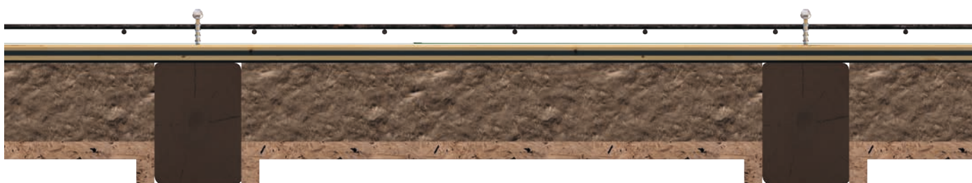
Sección transversal de la armadura de la capa de hormigón armado
