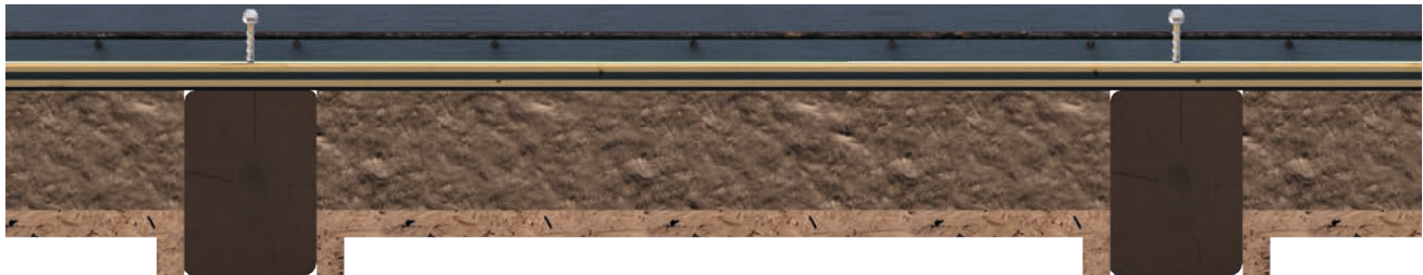
Sección transversal de un forjado estándar con vigas de madera maciza
