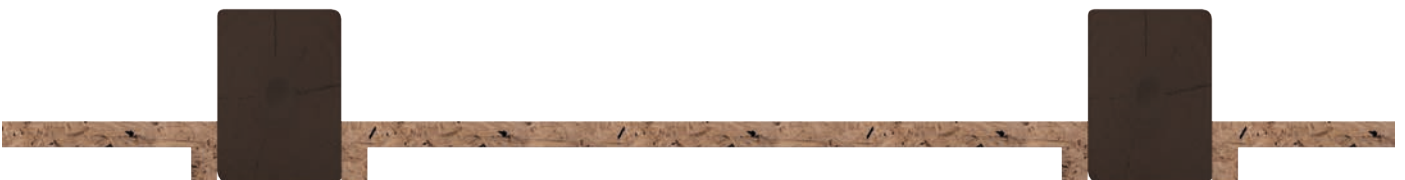
Sección transversal de un forjado desarmado
