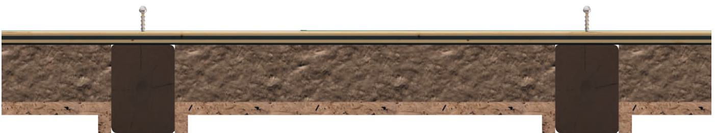
Sección transversal del forjado existente con los conectores instalados
