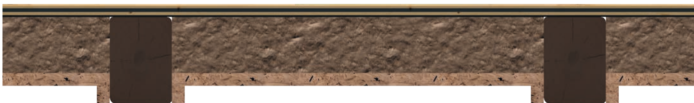
Sección transversal de un forjado existente con aislación, membrana y encofrado
