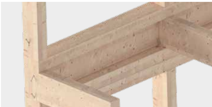
Mocowanie podpór w drewnianych konstrukcjach ramowych oraz połączeniach dźwigarów głównych i drugorzędnych
