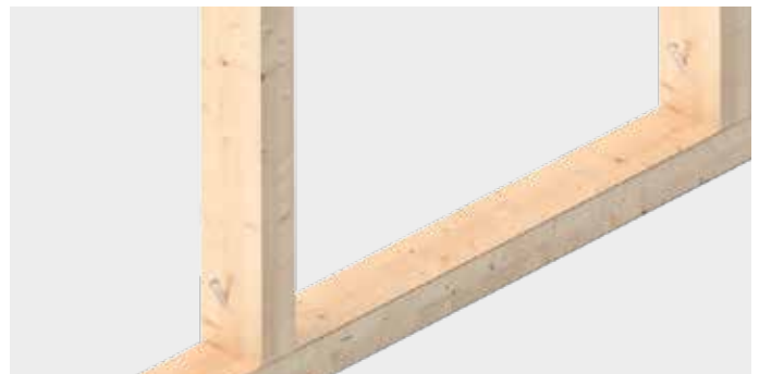
Mocowanie podpór w drewnianych konstrukcjach ramowych w obszarze podwaliny dolnej
