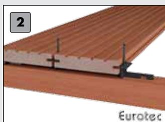
Equilibratura e il fissaggio delle tavole successive, avvitare con la punta a T finché tutte le tavole siano fissate.
