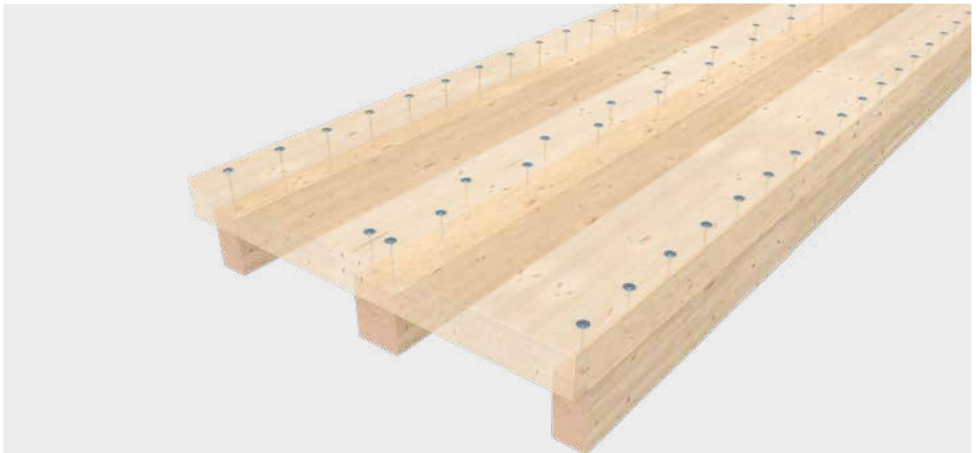
Presión de distribución en la unión de láminas de madera mediante adhesión con tornillos
