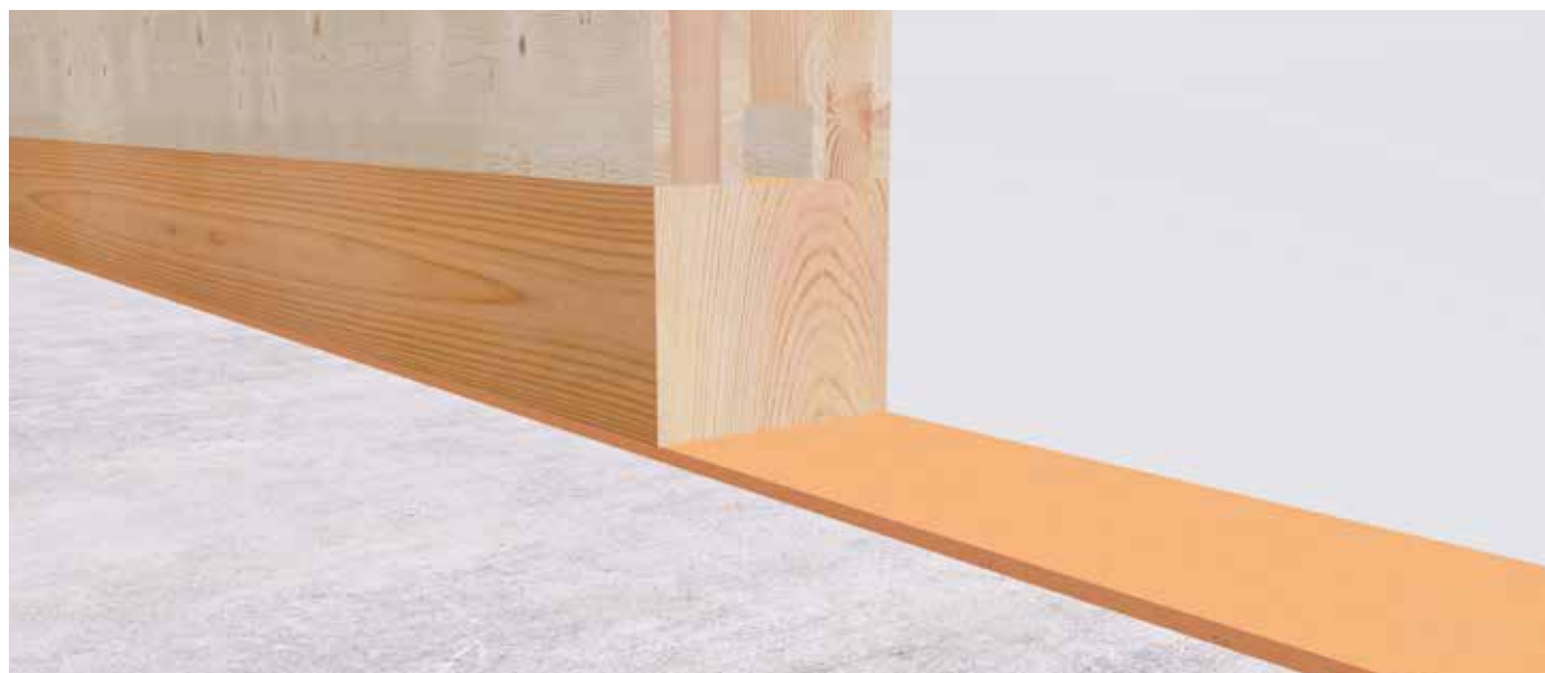
SonoTec aislamiento acústico de corcho en desacoplamiento de solera.
