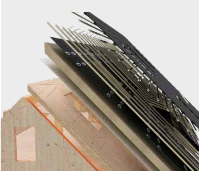
Construcción de tejado con tornillos Topduo.
