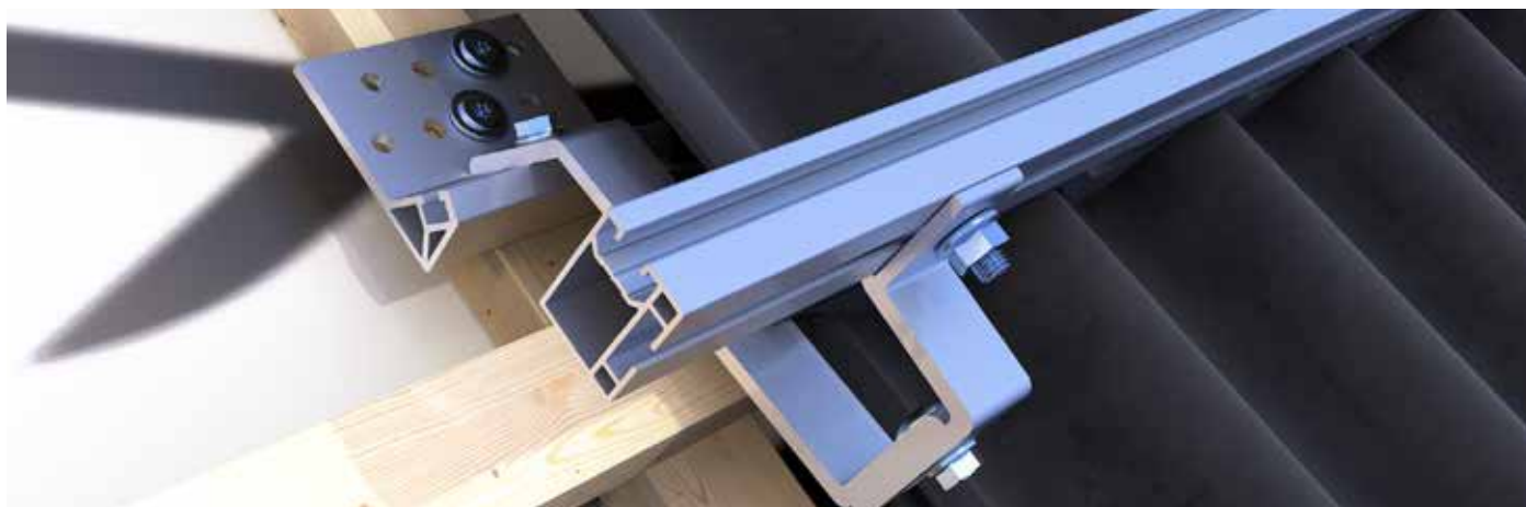
Dachhaken FLEX SLIM an der Konterlatte montiert, durch die ausgeklinkte Dachpfanne geführt und mit montiertem Montageprofil Steildach SLIM.
