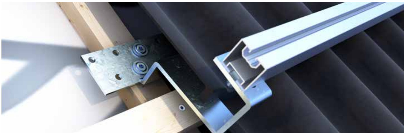
Dachhaken HEAVY an der Konterlatte montiert, durch die ausgeklinkte Dachpfanne geführt und mit montiertem Montageprofil Steildach.
