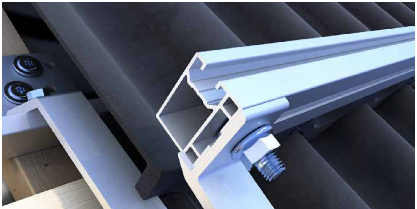
Montageprofil Steildach SLIM an Dachhaken FLEX SLIM mittels Hammerkopfschraube und Sperrzahnmutter befestigt.
