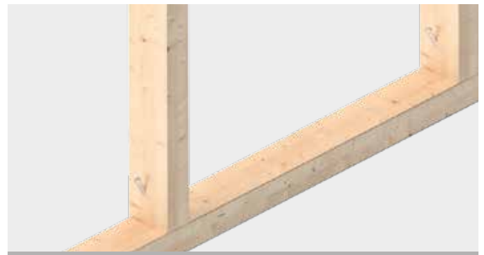
Fissaggio di supporti nelle strutture di telai in legno nelle zone dei davanzali
