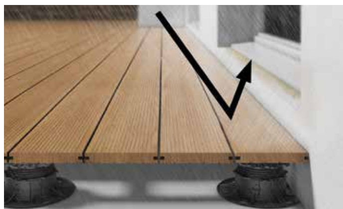
Senza DrainTec gli schizzi di acqua piovana rimbalzano sui componenti delle porte o sui rivestimenti delle facciate
