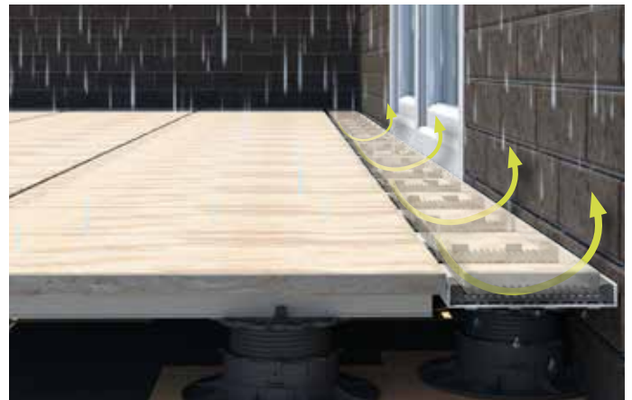
L'adattatore DrainTec permette lo scarico controllato dell'acqua piovana, inoltre in molti punti si creano retroventilazioni aggiuntive.
