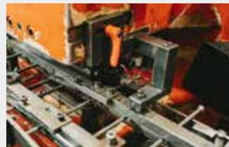
**4** Soldado (fusión de un corte de cable de acero de carbono)
