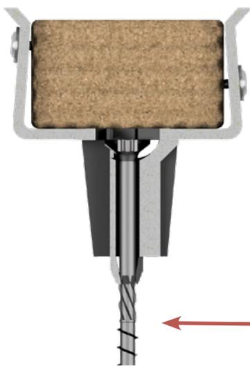
Vis pour ardoise Paneltwistec 4,0 x 30 mm
