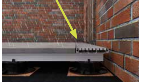
Avec la grille DrainTec, l'eau est déviée de manière contrôlée et coule directement dans le sous-sol.
