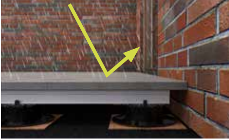
Sans grille DrainTec, l'eau de pluie est projetée sur les éléments de la porte ou le revêtement de la façade.
