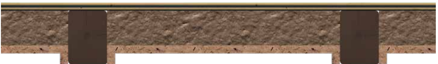
Bestandsdecke mit Dämmung, Folie und Schalung im Querschnitt
