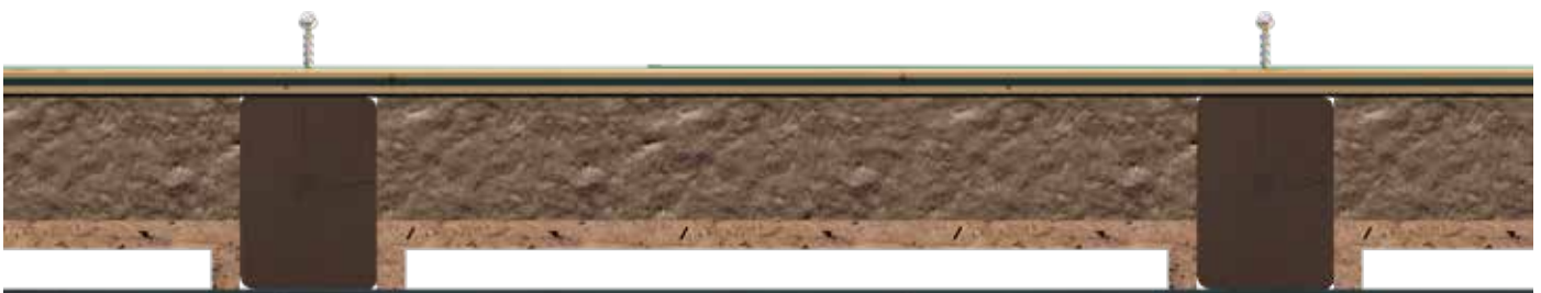
Bestandsdecke mit Verbindern im Querschnitt
