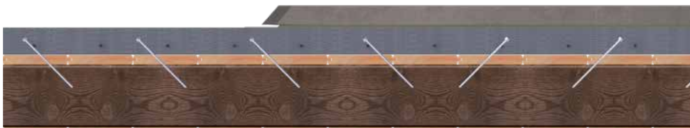
HBV-Decke, Trittschallentkopplung und Estrich im Querschnitt
