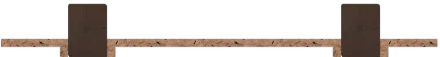
Rückbau einer Bestandsdecke im Querschnitt
