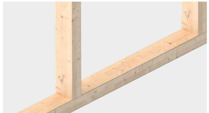
Befestigung von Stützen bei Holzrahmenkonstruktionen im Fußschwellenbereich
