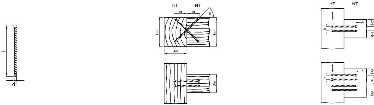
$a_1 = \text{min. } 40 \text{ mm}, a_2 = \text{min. } 24 \text{ mm}, k = \text{min. } 12 \text{ mm}$
