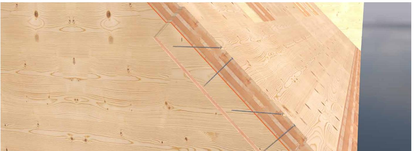
Verbindung von Dach- und Wandelement
