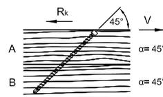
Charakteristischer Wert der Tragfähigkeit der Verbindung  $R_{k, \alpha}$  bzw.  $R_k$  nach ETA-11/0024
