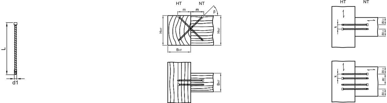
$a_1 = \text{min. } 50 \text{ mm}$ ,  $a_2 = \text{min. } 30 \text{ mm}$ ,  $k = \text{min. } 15 \text{ mm}$
