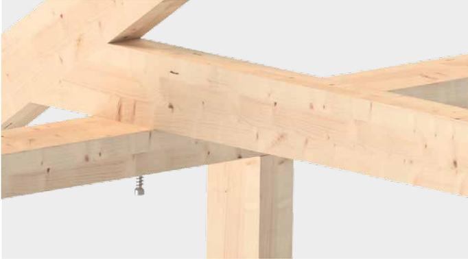
Befestigung von Querträgern bei leichten Holzrahmenkonstruktionen
