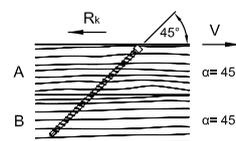
Charakteristischer Wert der Tragfähigkeit der Verbindung  $R_{ax,k}$  bzw.  $R_k$  nach ETA-11/0024
