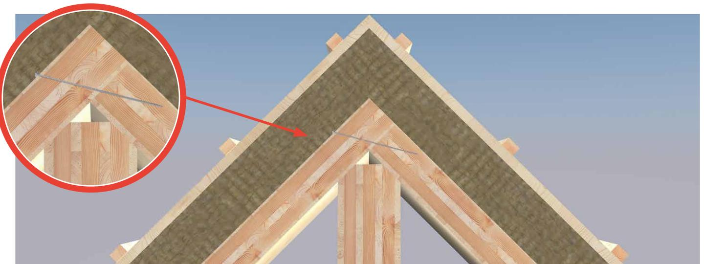
*Dachplatten auf Stoß – Schrägverschraubung*
