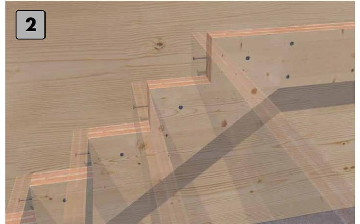
Stufenabschluss frontal an der Stufenauflage anbringen.
