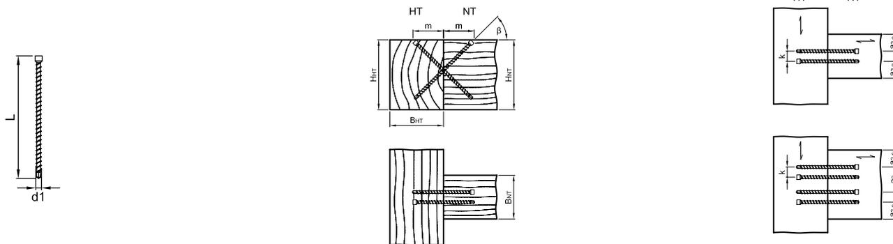
$a_2 = \text{min. } 33 \text{ mm}, a_{2t} = \text{min. } 20 \text{ mm}, k = \text{min. } 10 \text{ mm}$
