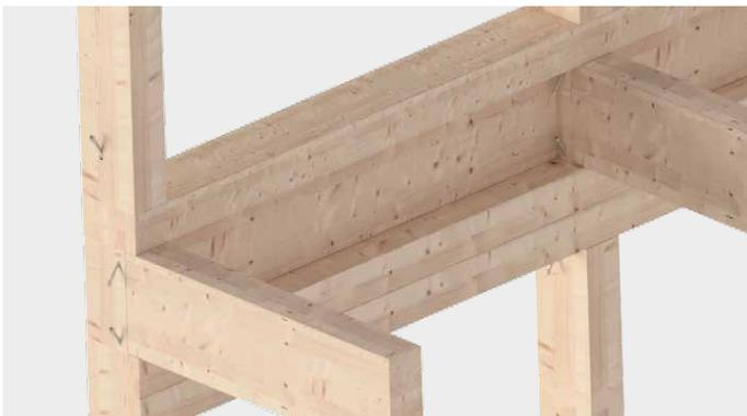
Befestigung von Stützen bei Holzrahmenkonstruktionen sowie Haupt-/Nebenträger-Anschlüssen
