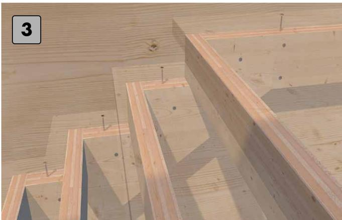
Stufen oben auf der Stufenauflage anbringen.
