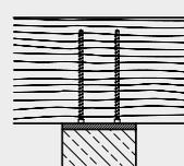
Querzugverstärkung an Ausklinkung
