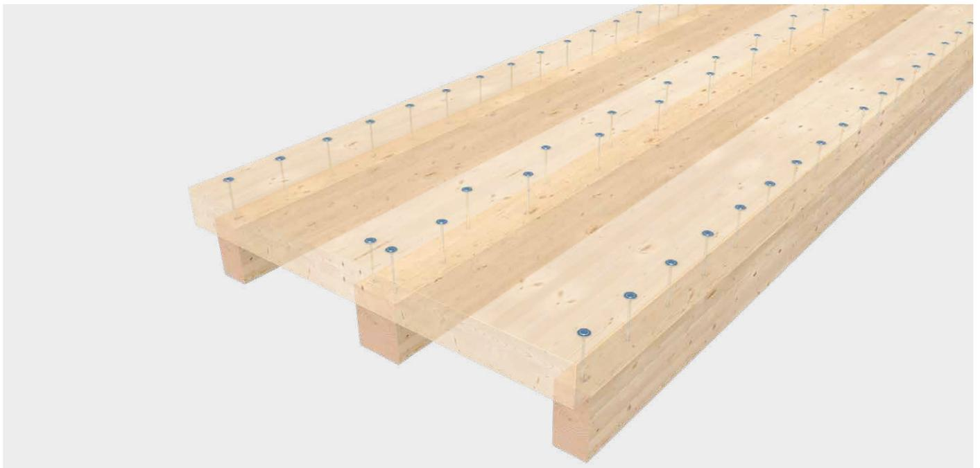
Pressdruckverteilung bei der Schraubenpressklebung von Holzrippenelementen
