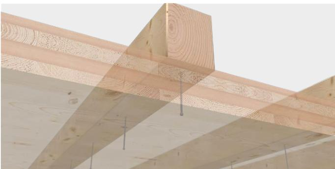
KonstruX DUO zur Befestigung eines Überzugs
