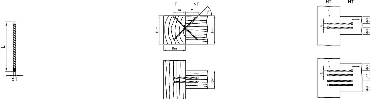
$a_2 = \text{min. } 33 \text{ mm}$ ,  $a_{2c} = \text{min. } 20 \text{ mm}$ ,  $k = \text{min. } 10 \text{ mm}$
