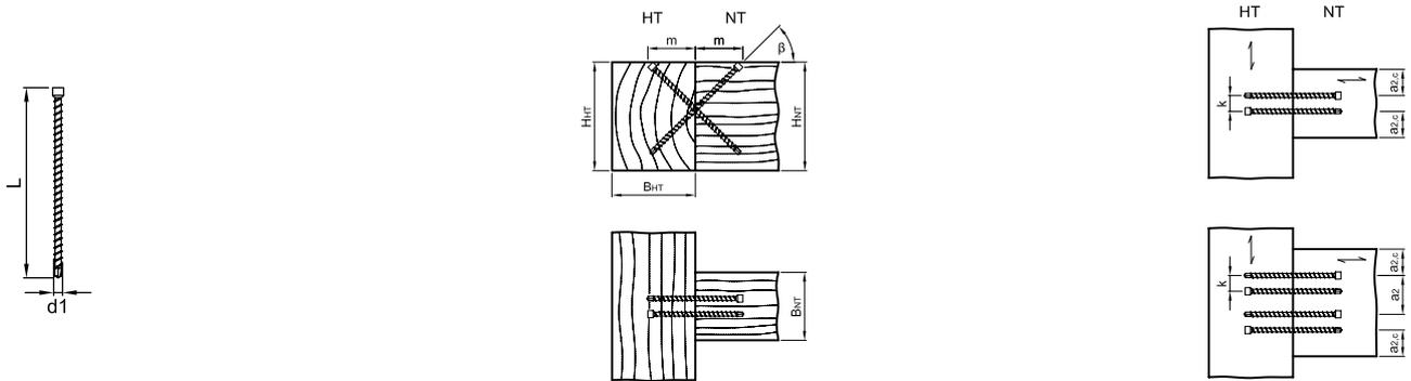
$a_2 = \text{min. } 50 \text{ mm}, a_{2,c} = \text{min. } 30 \text{ mm}, k = \text{min. } 15 \text{ mm}$
