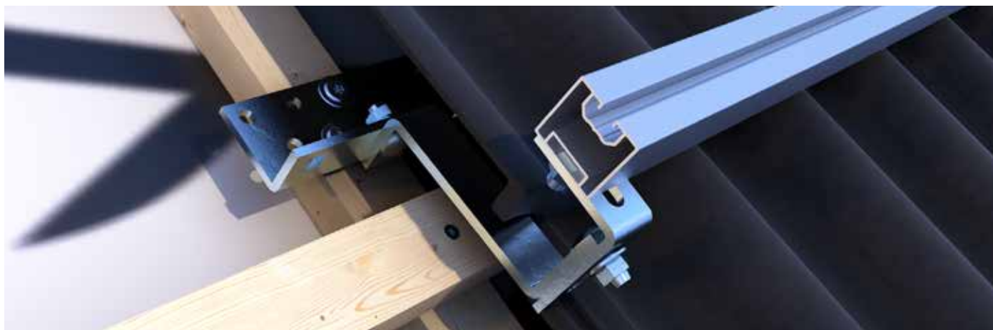
Gancio per tetti FLEX montato sul controlistello, condotto attraverso la tegola sganciata e con profilo di montaggio per tetti inclinati montato.
