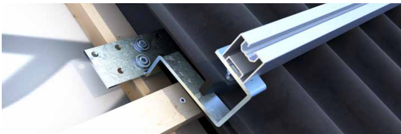
Gancio per tetti BASIC montato sul controlistello, condotto attraverso la tegola sganciata e con profilo di montaggio per tetti inclinati montato.
