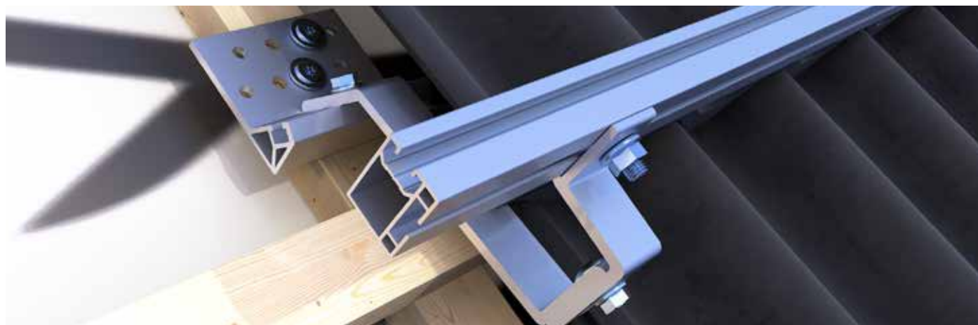
Gancio per tetti FLEX SLIM montato sul controlistello, condotto attraverso la tegola sganciata e con profilo di montaggio per tetti inclinati SLIM montato.
