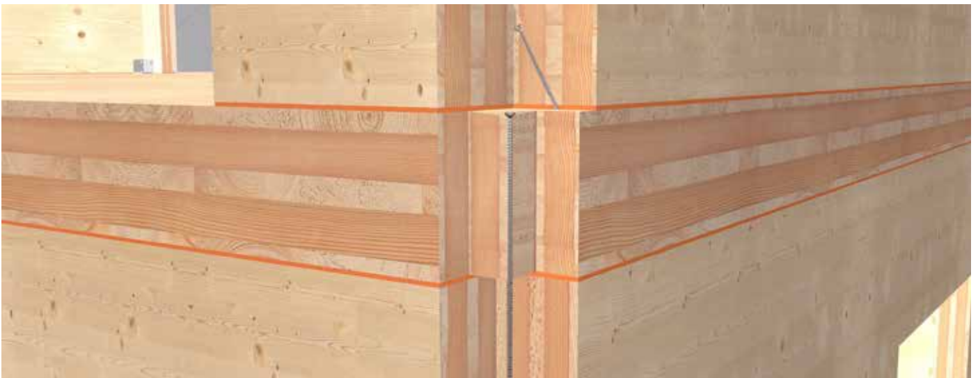
Conexión de pared y suelo de madera en el piso superior
