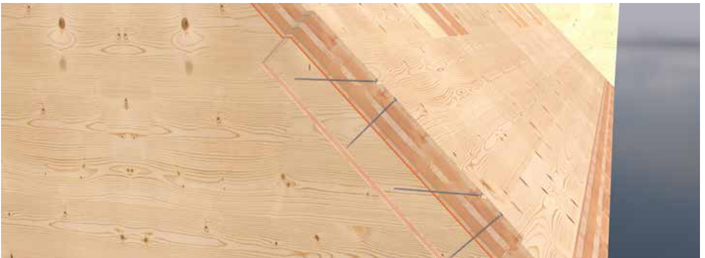
Conexión de elemento de tejado y pared
