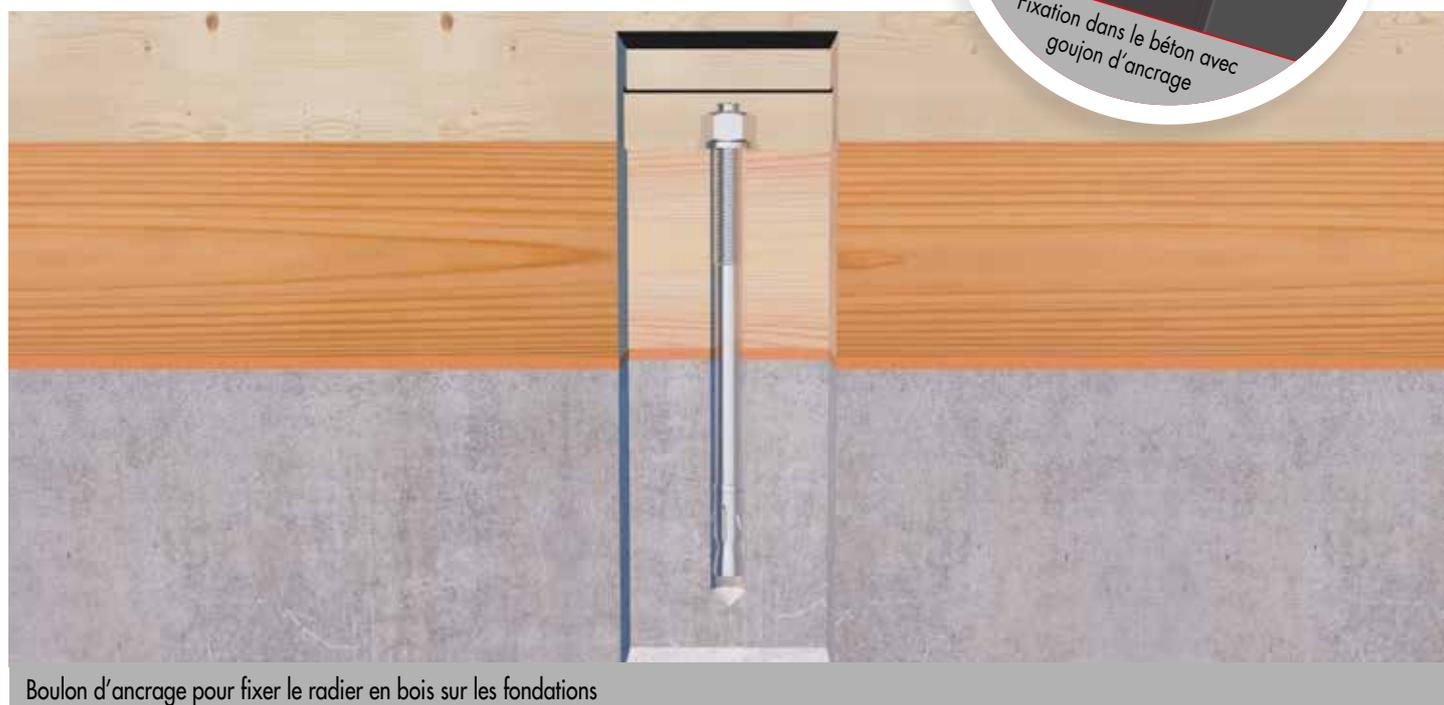
Boulon d'ancrage pour fixer le radier en bois sur les fondations
