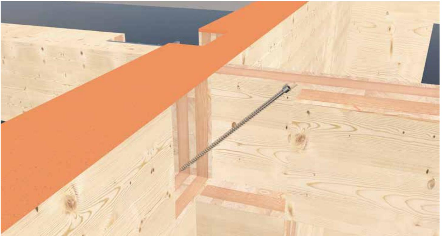
Assemblage de la paroi et de la poutre pour la solive de plafond.
