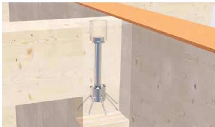
Application d'IdéeFix pour l'assemblage d'une colonne et d'un support de poutre
