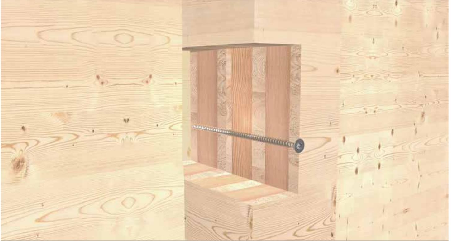
Assemblage de la paroi et du support pour la solive de plafond.
