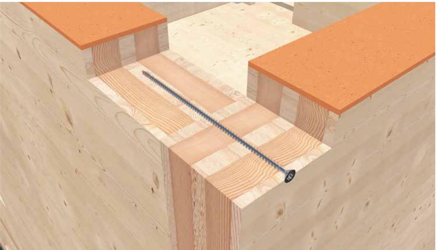
KonstruX pour l'assemblage de deux parois.
