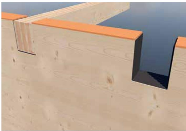
Application du profilé de découplage EPDM Silent sous poutres pour l'isolation acoustique entre les composants en bois.
