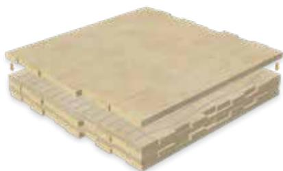
Lorsque le nombre de couches souhaité est atteint, les lamelles encollées sont compressées, la taille de panneaux possible étant définie par la taille du lit de presse. Dès que la colle a durci, le panneau en CLT est retouché afin d'éliminer les souillures, les résidus de colle ou le bois en dépassement. On procède ici par rabotage et par ponçage du panneau en CLT.
