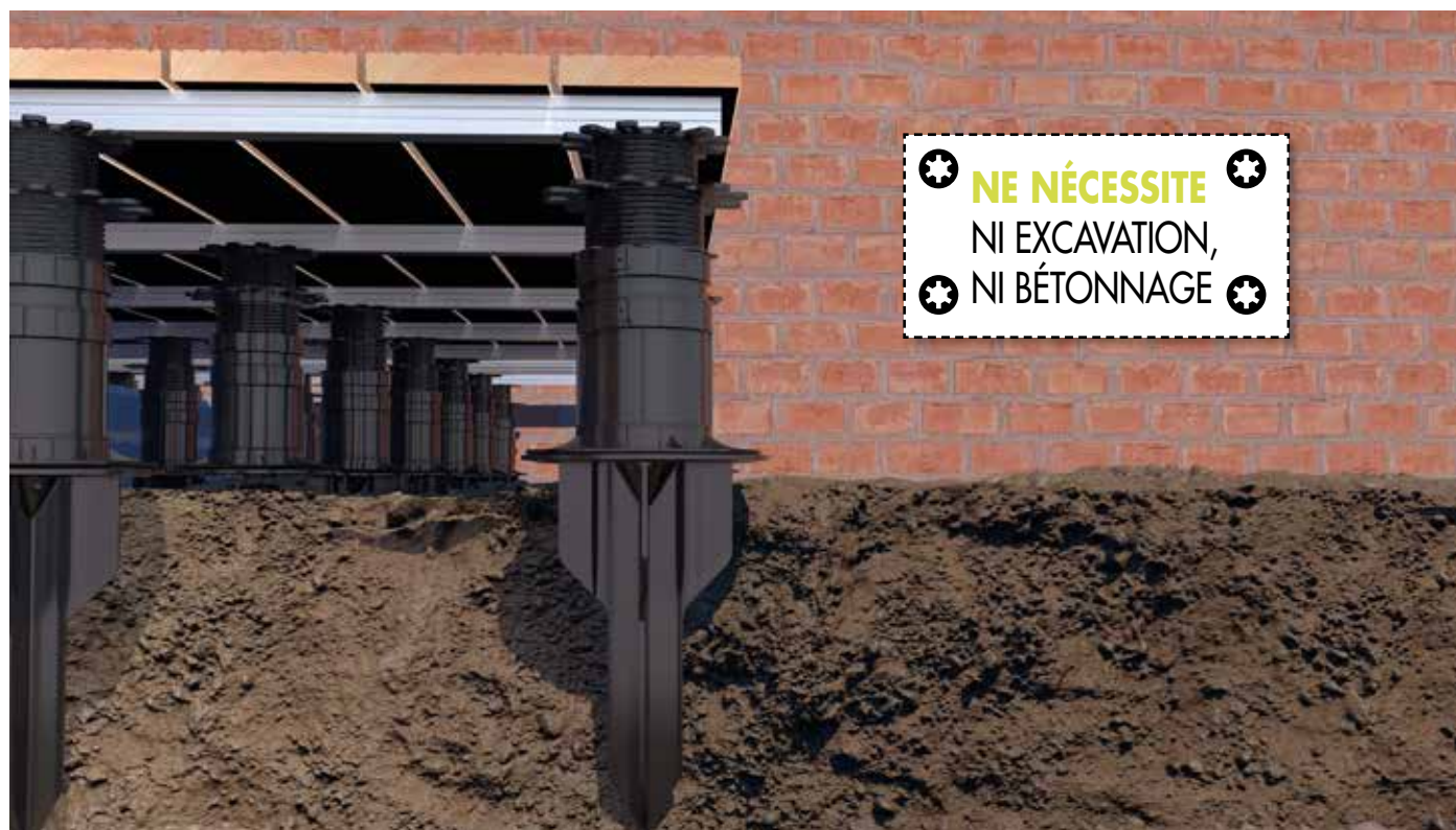
Tirant d'ancrage FLEXI en tant que base stable pour l'ossature porteuse de terrasse.
