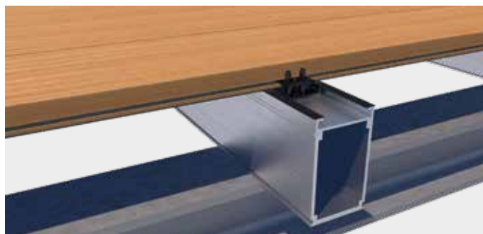
Fixation invisible avec support de système Twin
