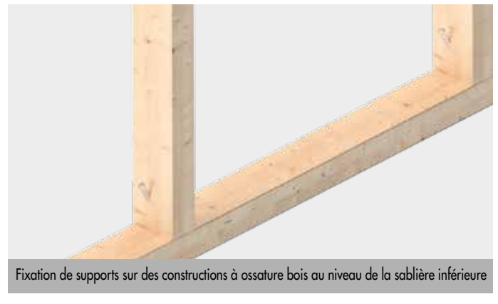
Fixation de supports sur des constructions à ossature bois
