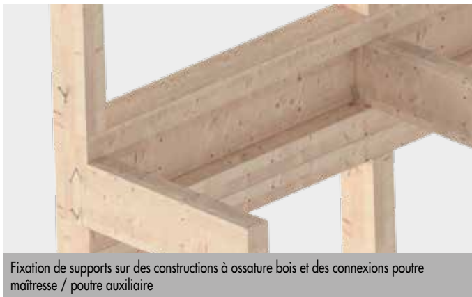
Fixation de traverses sur des constructions à ossature bois légères
