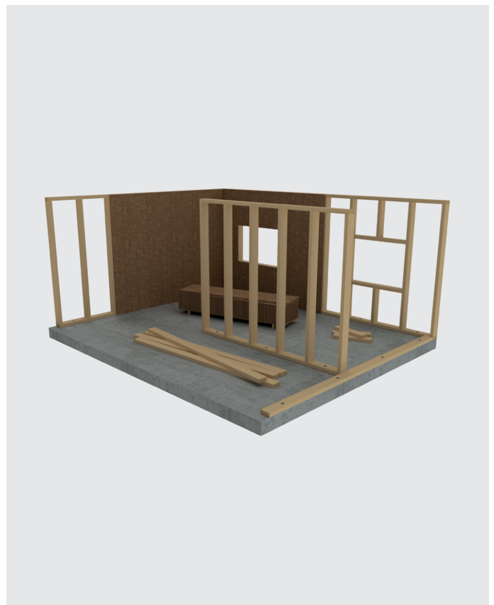
Gebäude mit Holzrahmenbauweise
