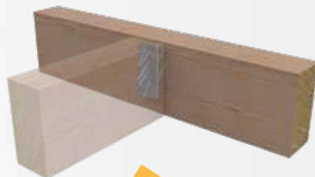
ATTACCO SUPPORTO PRINCIPALE-SUPPOR- TO SECONDARIO
