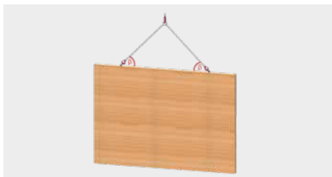
Parete o supporto BSH verticale, fibratura: verticale
