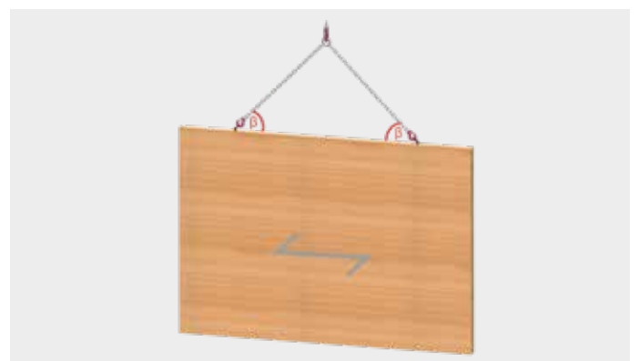
Parete o supporto BSH verticale, fibratura: orizzontale
