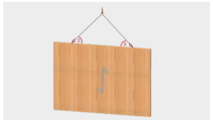
Parete o supporto BSH verticale, fibratura: verticale
