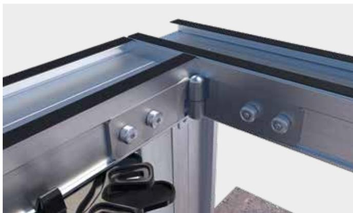
Le connecteur articulé EVO est un dispositif d'assemblage universel pour les profils nécessitant d'être fixés entre eux avec un angle autre que 90°. Il se visse facilement latéralement sur les profils et s'adapte ensuite très librement à chaque mesure d'angle souhaitée.
