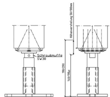
Le pied de poteau PediX peut être monté simplement à la section de bois de bout: Poser le joint sur le pied de poteau et placer les deux pièces au centre de la surface de bois de bout. Remarque: Pour faciliter le montage, plaque d'assise et douille de couverture peuvent être dévissées.
