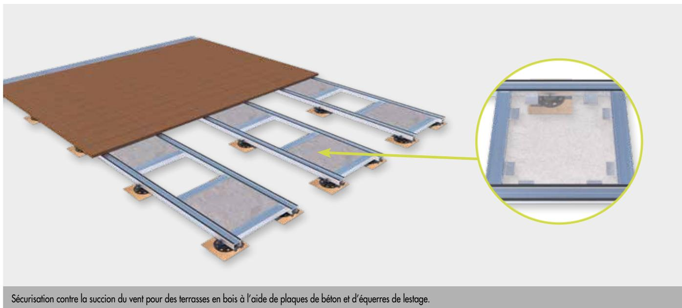
Sécurisation contre la succion du vent pour des terrasses en bois à l'aide de plaques de béton et d'équerres de lestage.
