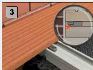
Insérez le composant 1 dans le composant 2. Ainsi, la lame de terrasse est fixée à la structure porteuse.
