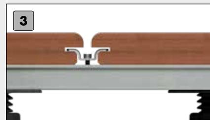
3 Posez les autres V-Clips et fixez à nouveau sans serrer ; les V-Clips précédents peuvent maintenant être serrés. Veillez au bon réglage du couple de torsion !
