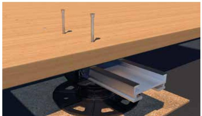
Fixation visible avec vis de forage pour profilés
