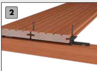
Redressement et fixation des prochaines planches, effectuer le vissage à l'aide du stick en T jusqu'à fixation de toutes les planches.
