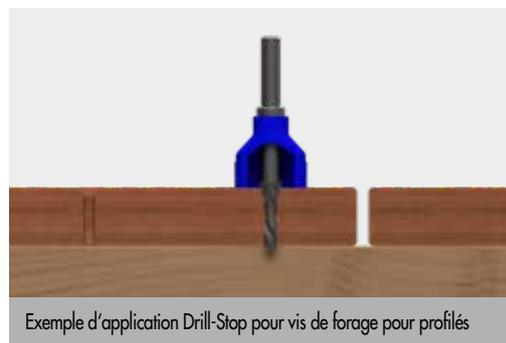
Exemple d'application Drill-Stop pour vis de forage pour profilés
