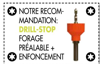
En cas de bois problématiques, il est toujours recommandé de procéder à un forage préalable des poutres. Ce sont notamment les bois durs / bois tropicaux, mais aussi quelques résineux tendant facilement au déchirement, tels que le pin d'Oregon. Un forage préalable empêche un déchirement des poutres. Lors d'écartements en bordure, veiller à observer un écartement d'au moins 6 cm de l'extrémité de la planche.
