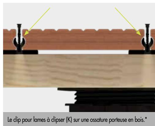
Le clip pour lames à clipser (K) sur une ossature porteuse en bois.\*
