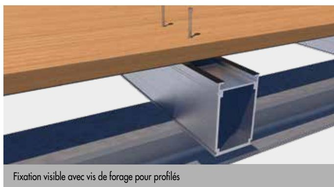
Fixation visible avec vis de forage pour profilés
