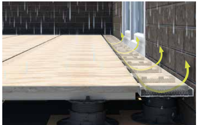
Adapter Draintec umożliwia kontrolowany odpływ wody deszczowej, ponadto w wielu punktach szczegółowych powstaje dodatkowa wentylacja tylna.
