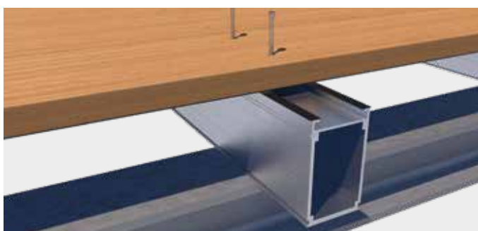
Zamocowanie widoczne przez profilowy wkręt samowiercący
