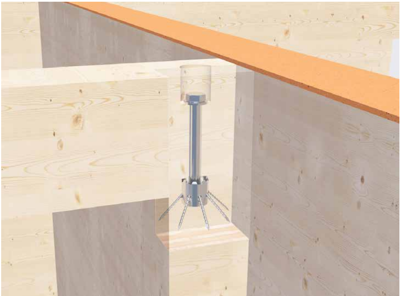
Application d'IdeeFix pour l'assemblage d'une colonne et d'un support de poutre
