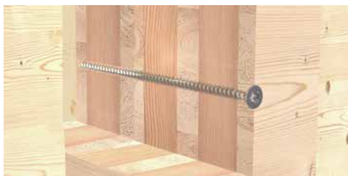
Assemblage de la paroi et du support pour la solive de plafond.
