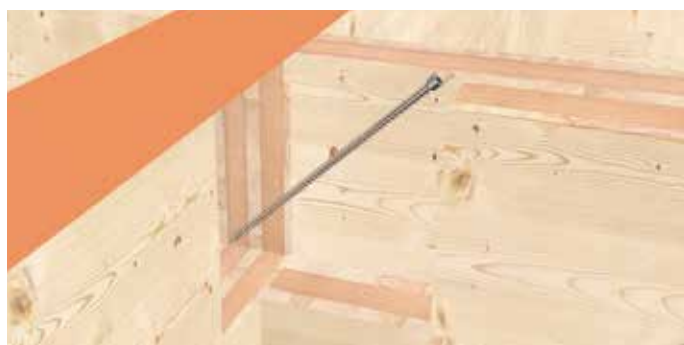
Assemblage de la paroi et de la poutre pour la solive de plafond.
