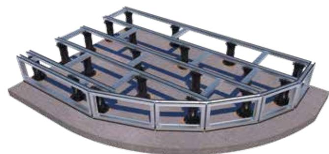
**4** Collegare tra loro gli elementi laterali con il **connettore a cerniera EVO** e fissare al suolo mediante la **piastra angolare per calcestruzzo in alluminio**.
