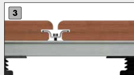
3 Inserire altre V-Clip e fissare di nuovo leggermente, le V-Clip retrostanti possono ora essere serrate. A questo punto prestare attenzione alla regolazione corretta della coppia di serraggio!
