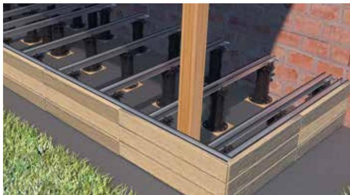
**8** I **profili modulari in alluminio EVO** vengono incastrati sui **pedi regolabili nell'adattatore Click** e poi **pedi regolabili** ulteriormente calibrati in altezza. Infine i profili vengono fissati alla parete dell'edificio con l'angolare di connessione a parete e le **viti Sprengler** con tasselli.
