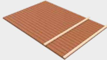
**3** Avvitare il profilo a rombo inferiore attraverso la struttura di supporto utilizzando le viti per facciate ZK.
