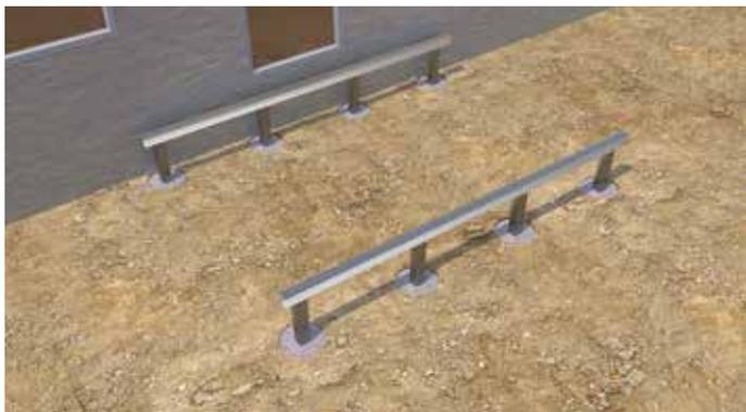
**2** I **profili portanti HKP** vengono distribuiti uniformemente sulla struttura in acciaio. Come strato di separazione tra i profili e l'acciaio sono utilizzati i **distanziali Rolfi**.
