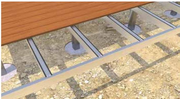
**6** Nell'ultima fase vengono applicati i rivestimenti laterali. A tale scopo, in precedenza i lati esterni del **profilo portante HKP** vengono incollati con il **nastro per facciate in EPDM**. Infine vengono fissate le tavole di legno desiderate con la **vite auto perforante per profili**.
