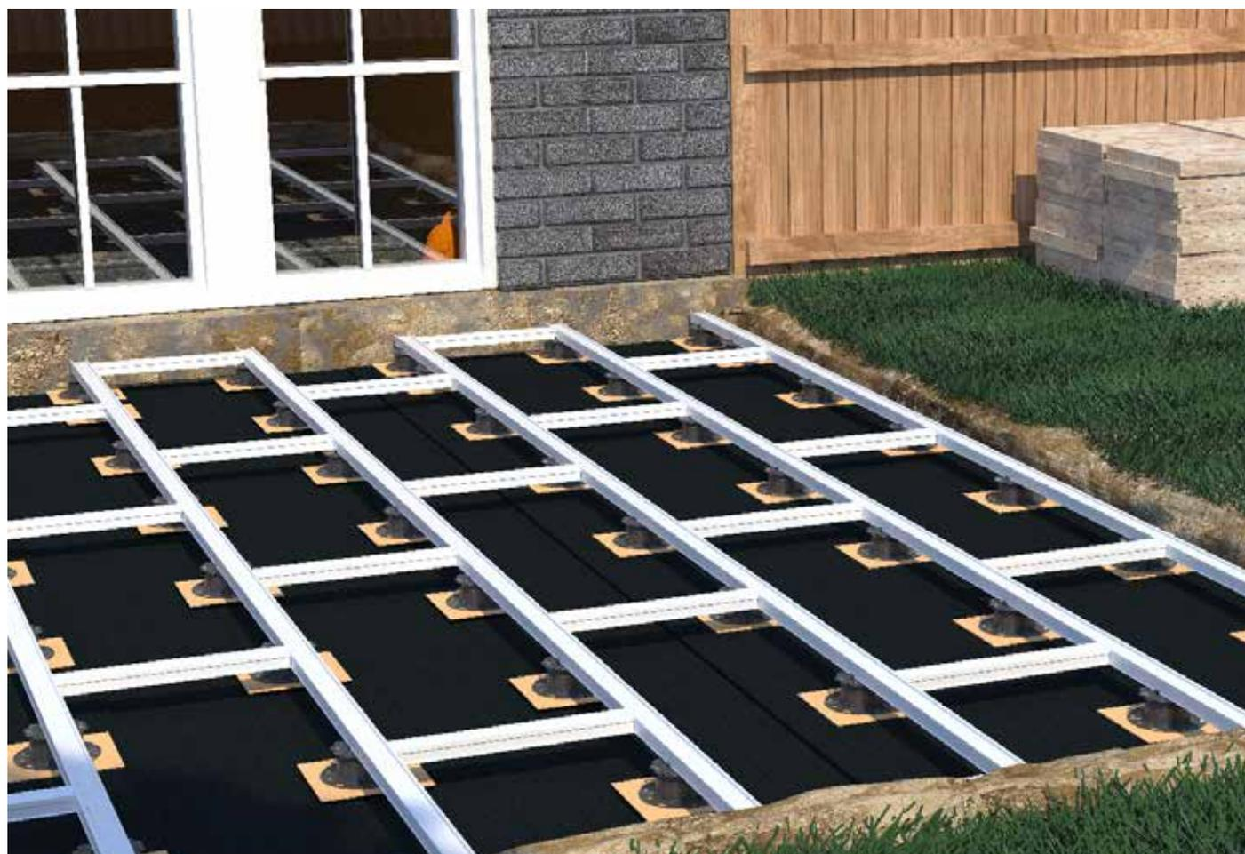
Sottostruttura con piede regolabile PRO, profili modulari in alluminio EVO e montanti trasversali EVO
