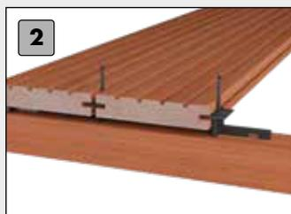
2 Equilibratura e il fissaggio delle tavole successive, avvitare con la punta a T finché tutte le tavole siano fissate.
