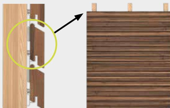
Per le aree in cui si trovano finestre, porte, giunzioni delle tavole o la fine della facciata, si possono formare punti fissi grazie alla perforazione delle Clip per facciate Rhombus. Per questo, avvitare la clip viene prima sul retro del profilo. Successivamente avvitare la clip con il bordo inferiore.
