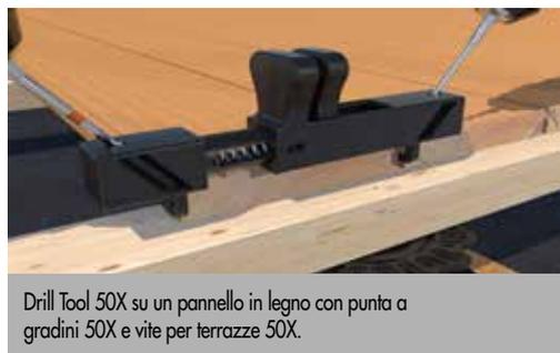
Drill Tool 50X su un pannello in legno con punta a gradini 50X e vite per terrazze 50X.
