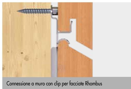
Connessione a muro con clip per facciate Rhombus
