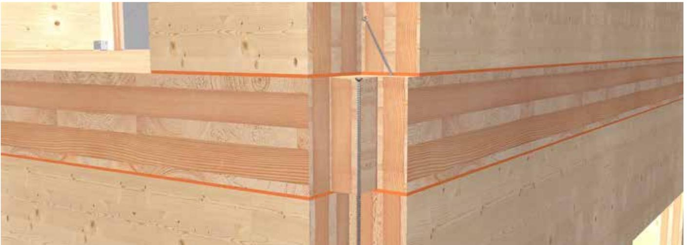
Conexión de pared y suelo de madera en el piso superior
