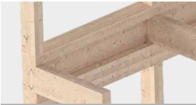
Fijación de soportes en construcciones de marcos de madera, así como en conexiones entre vigas principales y secundarias
