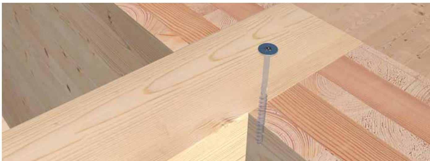
Wkręt z gwintem częściowym SawTec służy do mocowania podciagu w wyciętej ścianie CLT.
