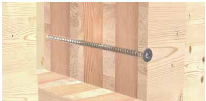
Połączenie ściany ze wspornikiem w podciągu stropowym.
