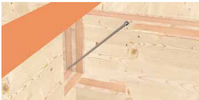
Połączenie ściany z belką w podciągu stropowym.
