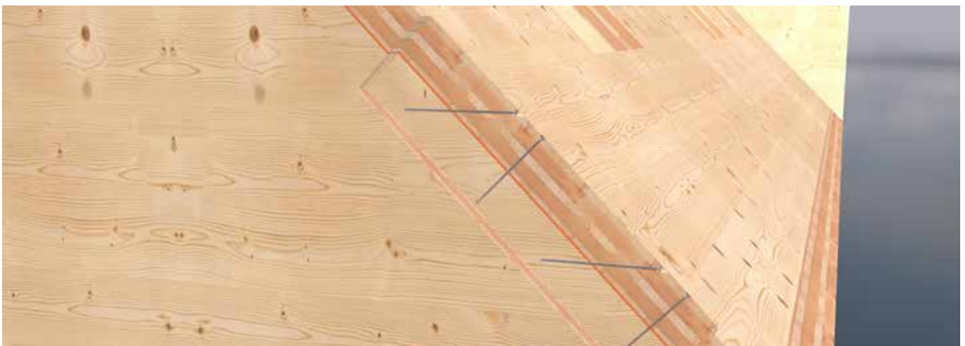
Łączenie elementu dachowego i ściennego.
