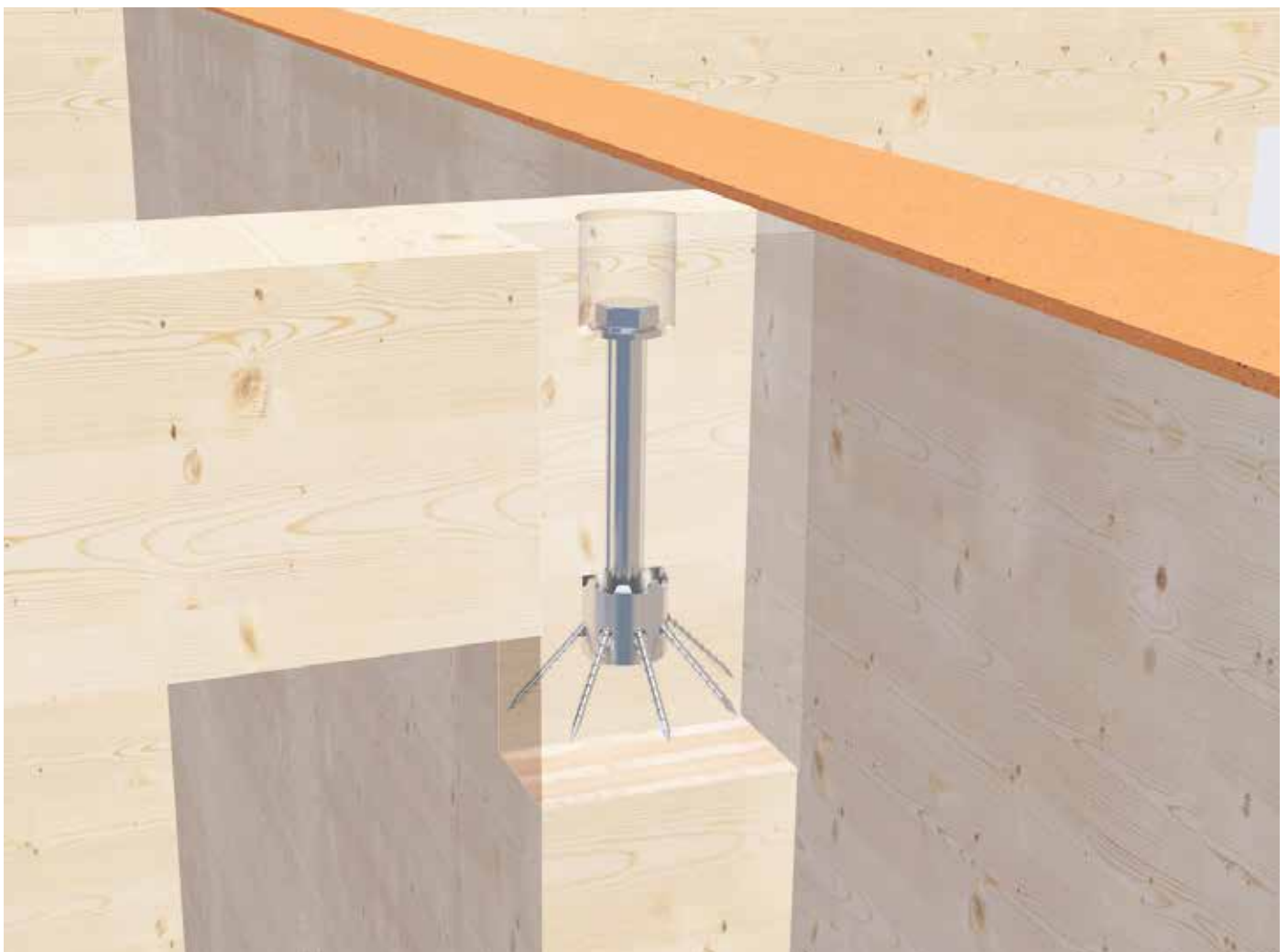
Aplikacja IdeeFix do łączenia słupów i dźwigarów
