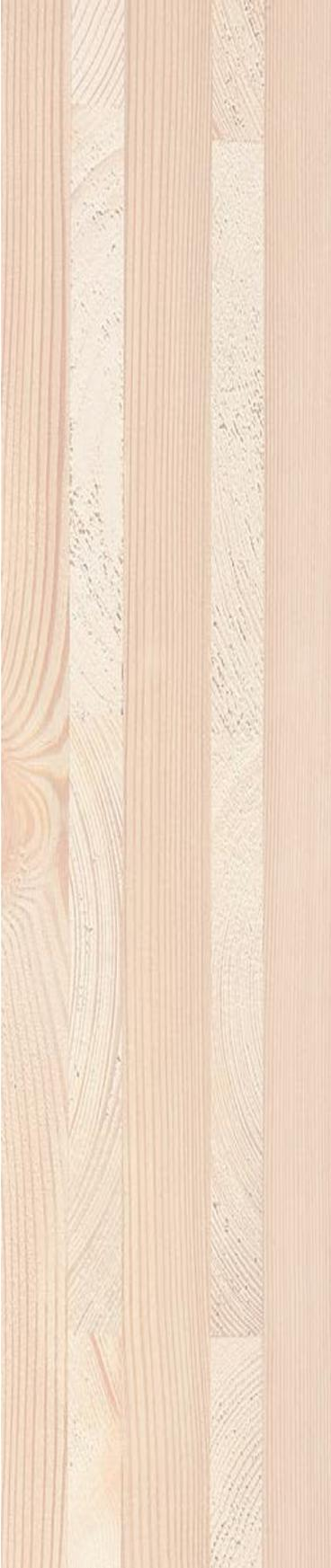
CLT-Platten (engl. Cross Laminated Timber) bzw. Brettsper Holz bestehen aus **mehreren Schichten von Holzbrettern**, die kreuzweise (typischerweise in einem Winkel von 90 Grad) gestapelt und auf ihren breiten Flächen und teilweise auch auf den schmalen Flächen zusammengeklebt sind.
