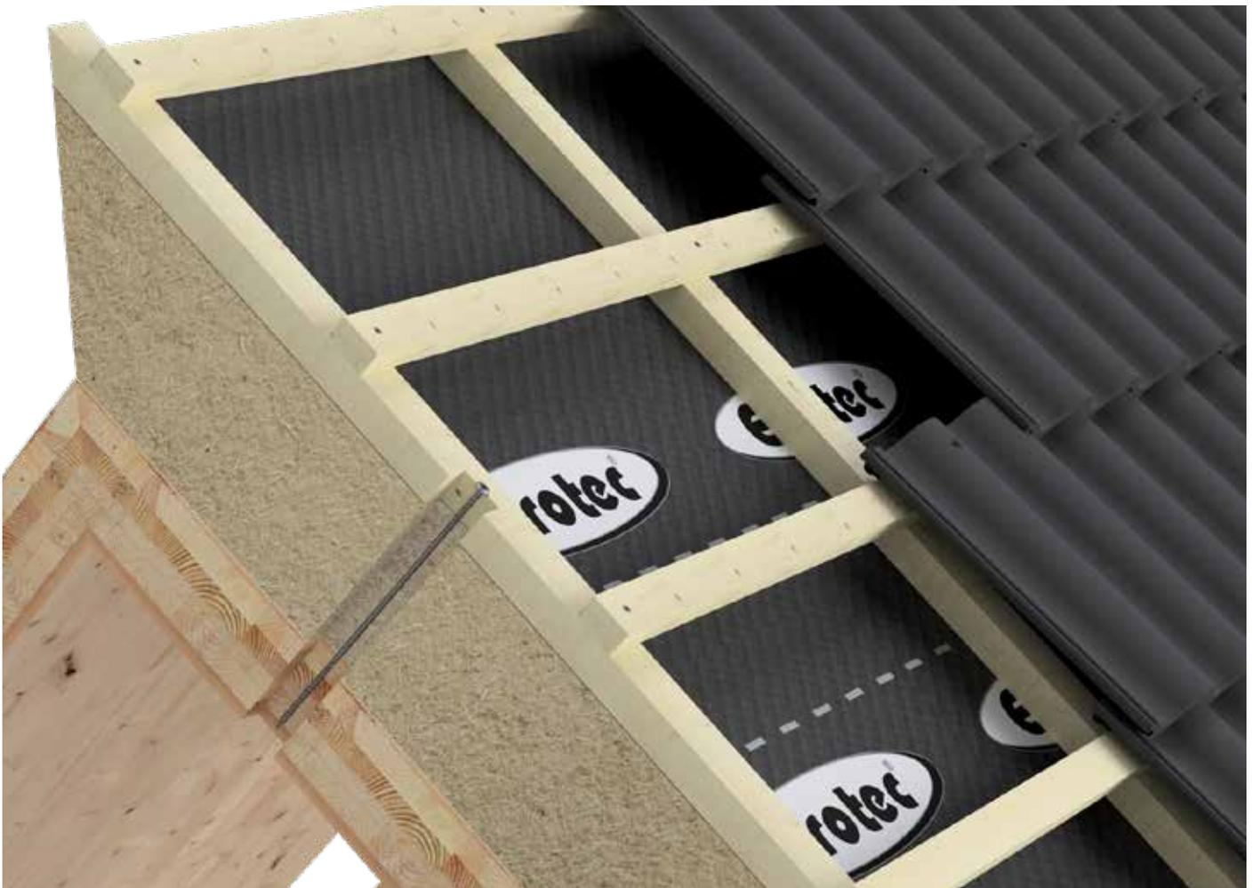
Topduo Tellerkopf zum Befestigen von Dämmmaterial.
