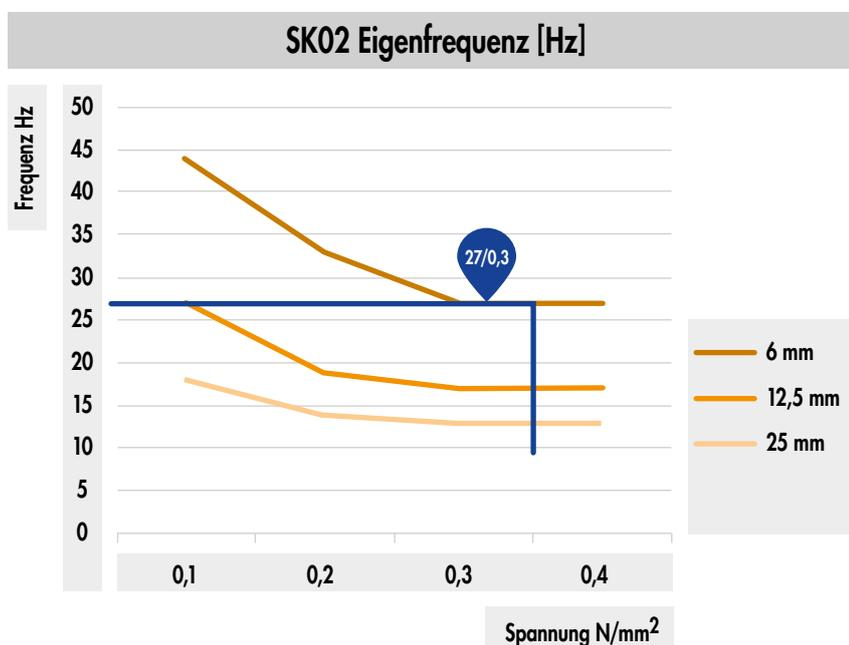
Im **nächsten Schritt** schauen wir uns die Störfrequenz genauer an. Dazu betrachten wir die folgenden Graphen und können somit feststellen, dass sich die Schallreduzierung im Niederfrequenzbereich verschlechtert hat. Niedrige Frequenzen (Bässe) lassen sich nur durch Masse isolieren. Die für die Bauakustik zu isolierenden Frequenzen beginnen im Bereich von 80 Hz, weshalb dies zu vernachlässigen ist. Wenn keine Störfrequenzen vorgegeben sind, kann von 80 Hz ausgegangen werden.
