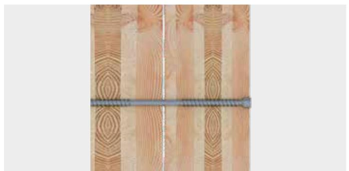
KonstruX DUO Schnittansicht zwischen zwei Bauteilen
