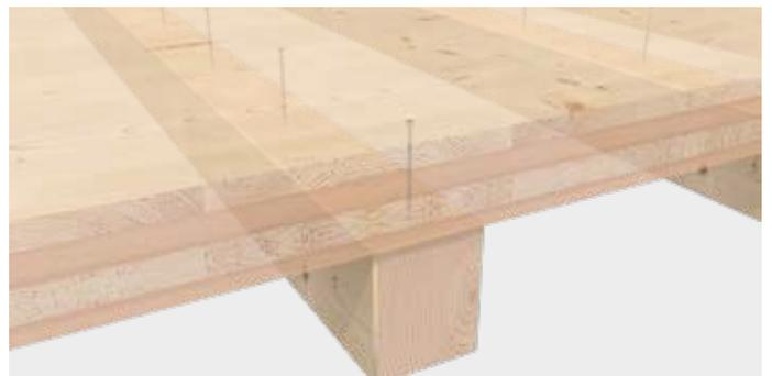
KonstruX DUO zur Befestigung eines Unterzugs
