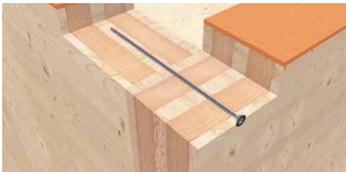
KonstruX zur Verbindung von zwei Wänden.
