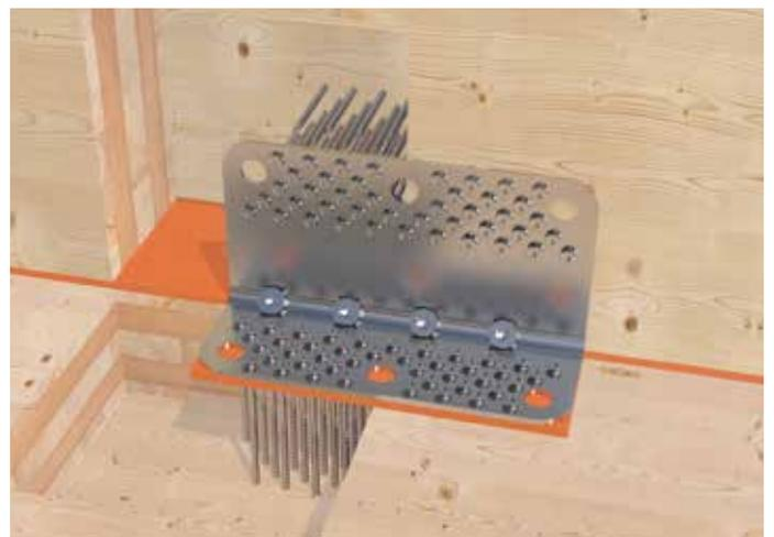
Systemwinkel CLT zur Befestigung einer Wand am Holzfußboden des Obergeschosses.
