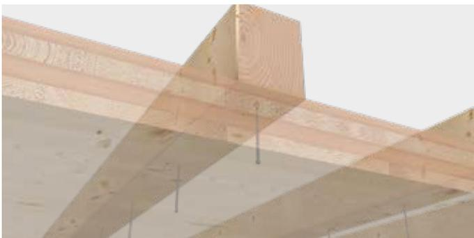
KonstruX DUO zur Befestigung eines Überzugs
