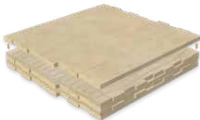
Auf die geleimte Schicht wird eine weitere Schicht aufgelegt. Diese wird dabei so ausgerichtet, dass die Faserrichtung der neuen Lage im Winkel von 90° zu den Fasern der Platte darunter verläuft. Im Anschluss wird auf die neue Lage ebenfalls Leim aufgetragen. Dieser Vorgang wird so lange wiederholt, bis die gewünschte Anzahl an Brettschichten erreicht ist.
