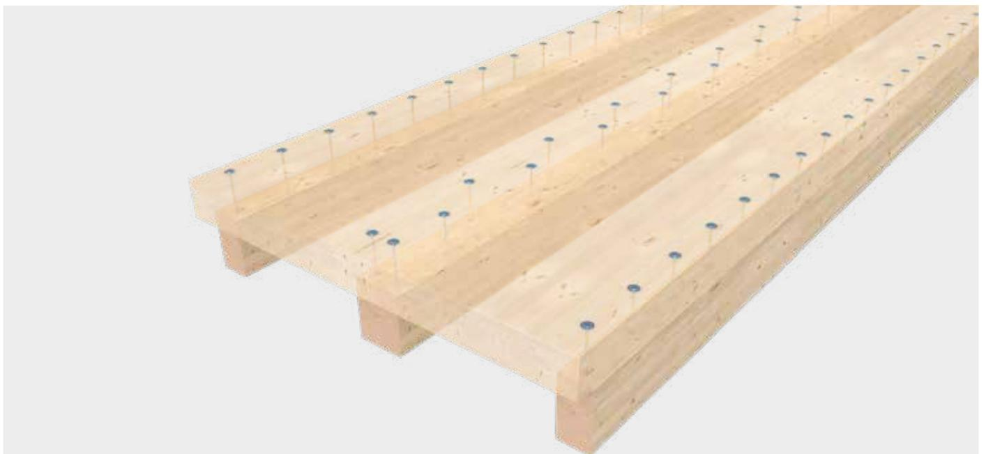
Pressdruckverteilung bei der Schraubenpressklebung von Holzrippenelementen
