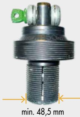
Il diametro dell'elemento di sostegno, quando è chiuso, non deve essere inferiore a 48,5 mm.
