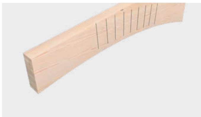
Refuerzo de vigas trapezoidales curvadas
