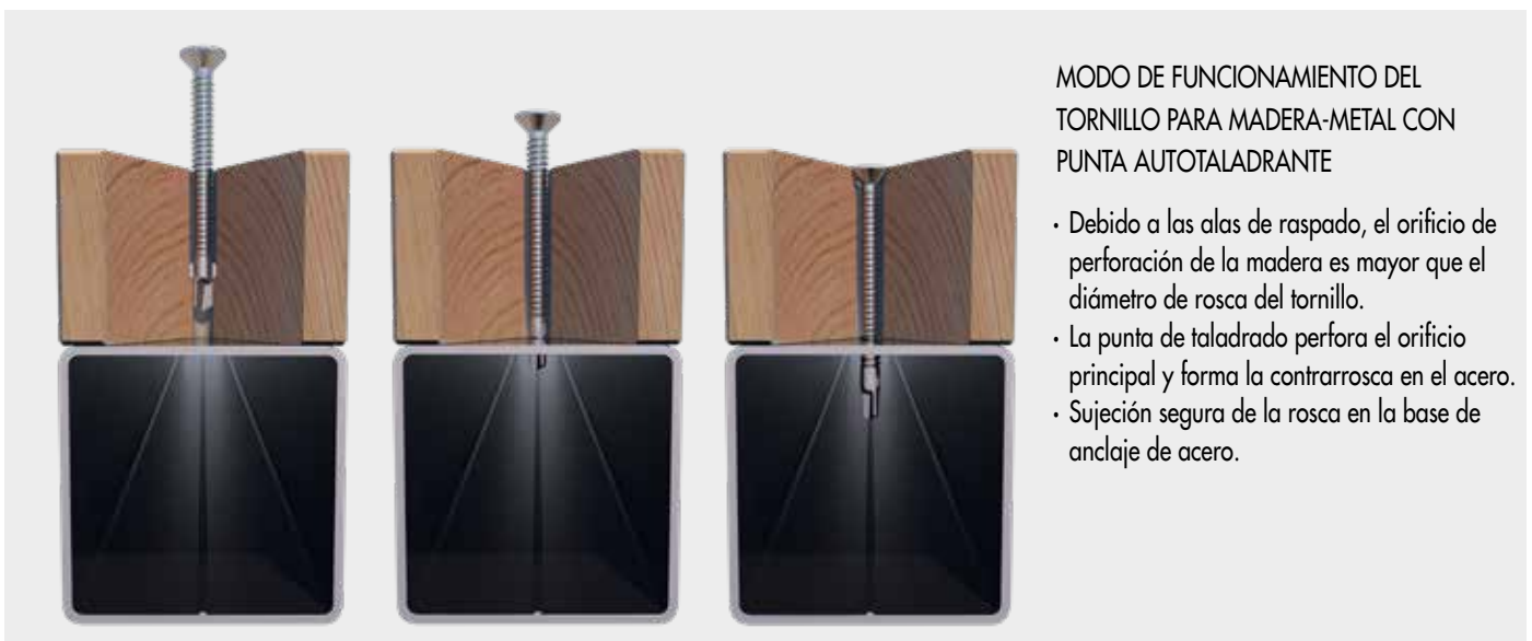
Modo de funcionamiento del tornillo para madera-metal con punta autotaladrante
