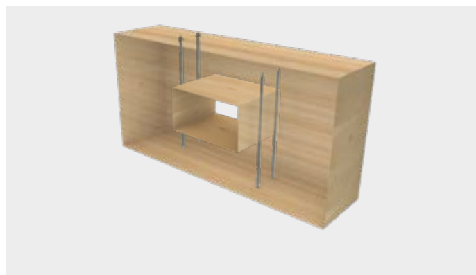
Refuerzo de aberturas de vigas
