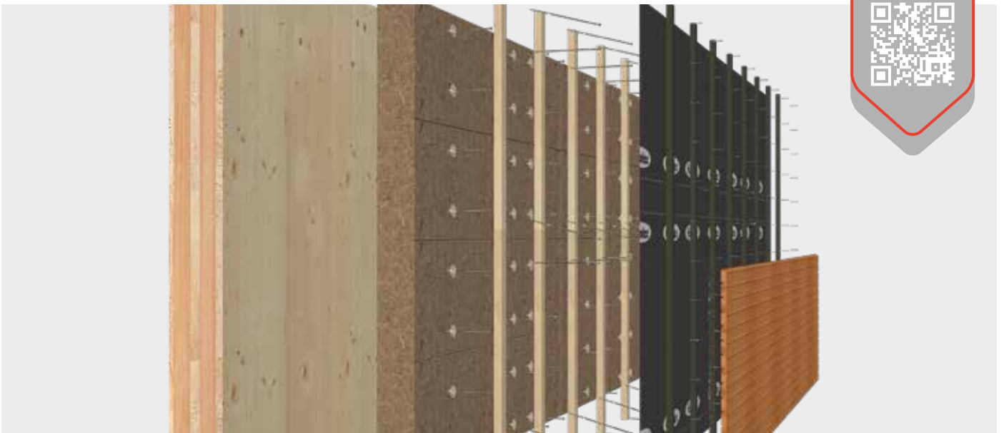
Estructura de fachada con Topduo
