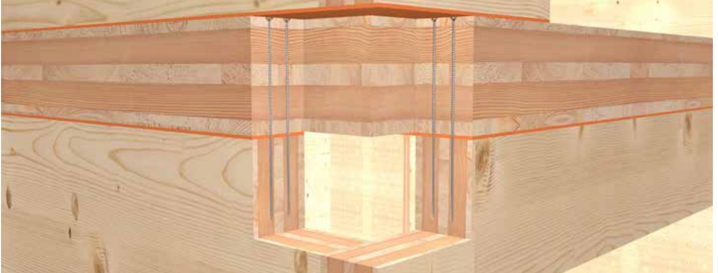
Conexión de elemento de pared y techo
