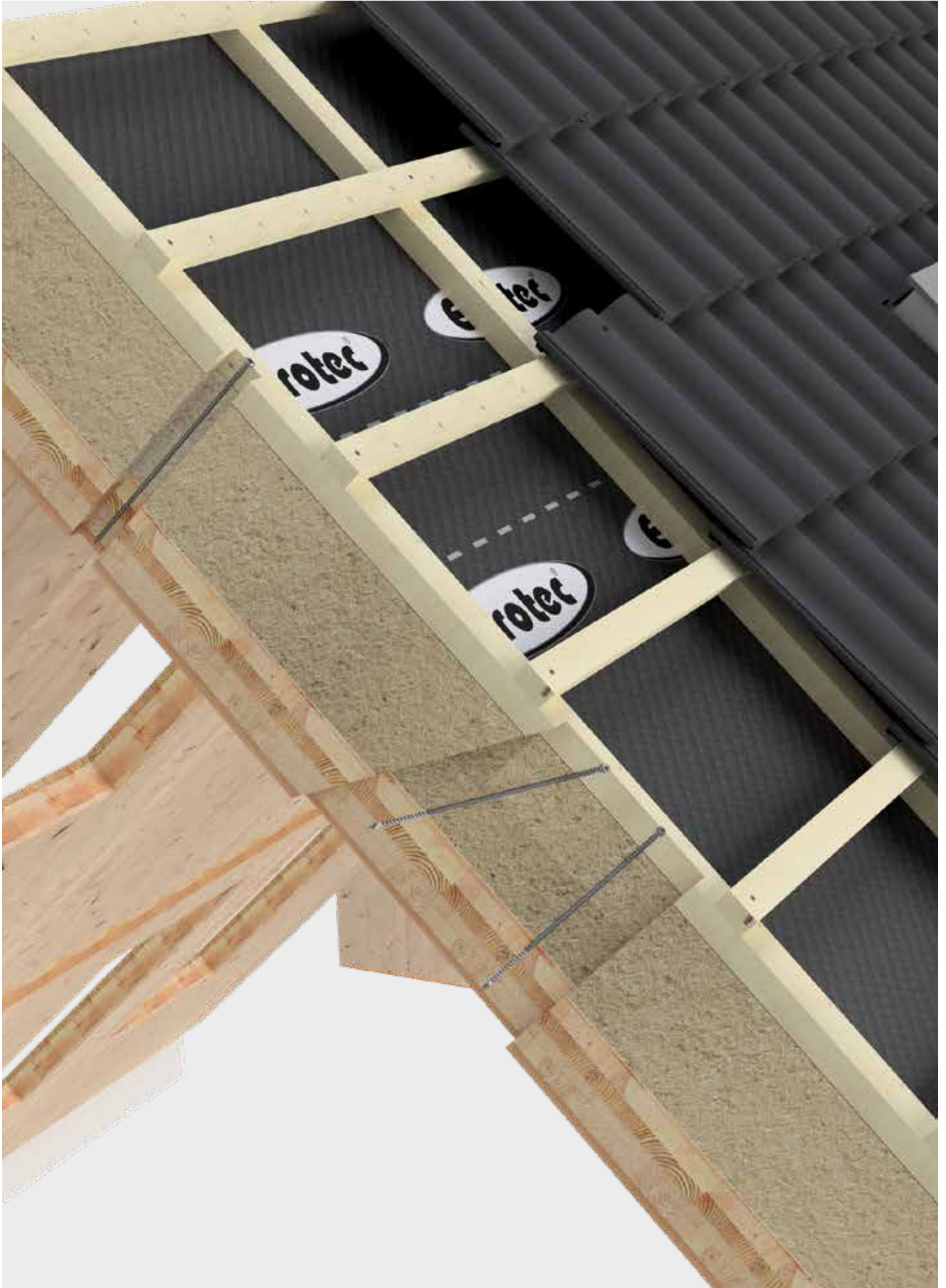
Topduo Tellerkopf zum Befestigen von Dämmmaterial
