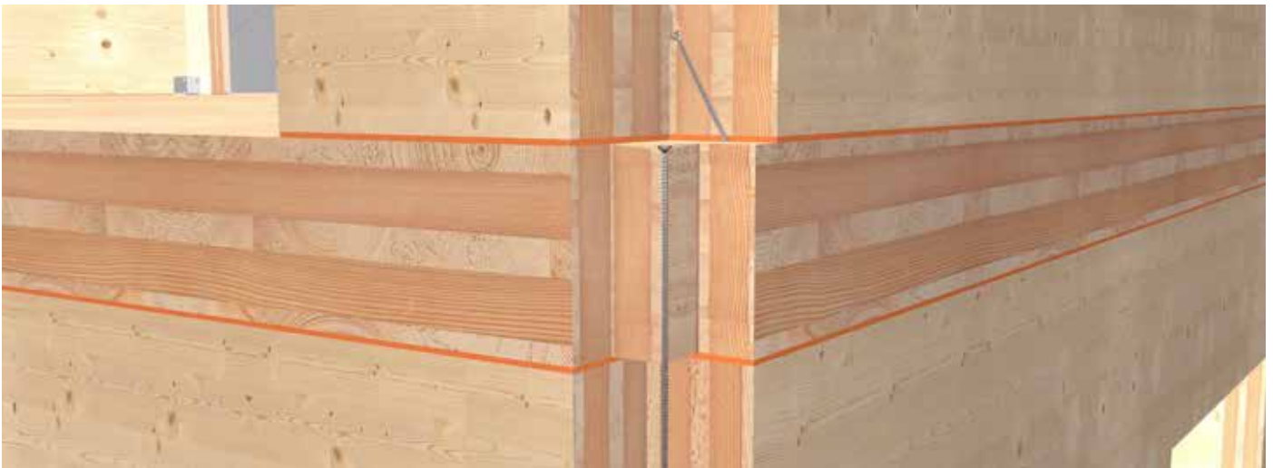
Verbindung von Wand und Holzboden im OG
