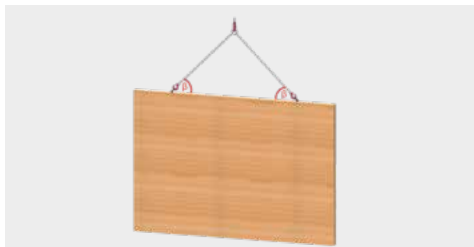
Pared o soporte de madera laminada en posición vertical, sentido de las fibras: vertical
