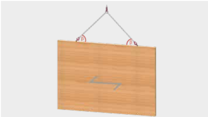
Pared o soporte de madera laminada en posición vertical, sentido de las fibras: horizontal
