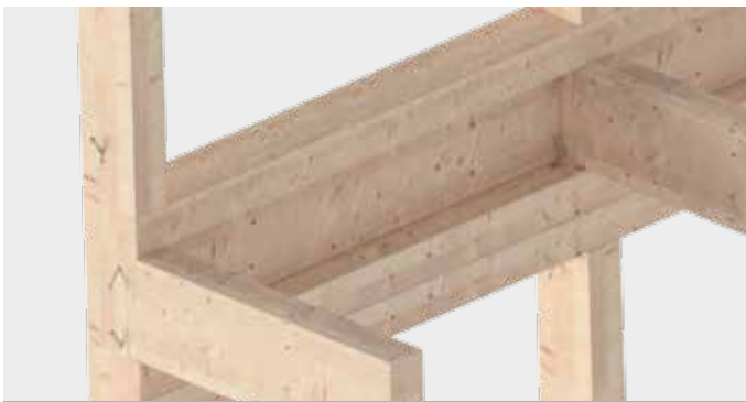
Fijación de soportes en el caso de construcciones de marcos de madera y también en el caso de conexiones entre vigas principales y secundarias
