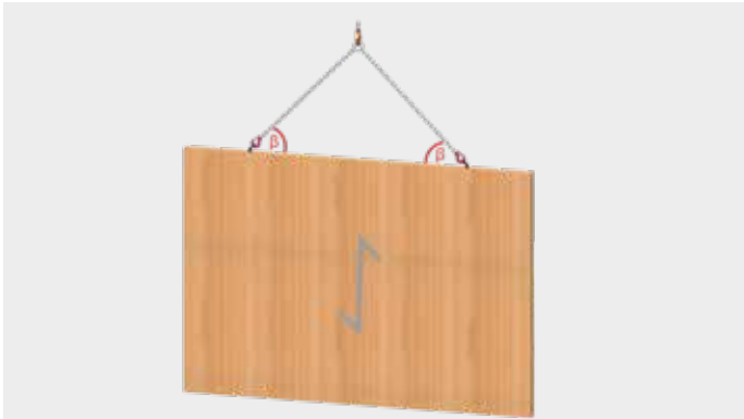
Pared o soporte de madera laminada en posición vertical, sentido de las fibras: vertical
