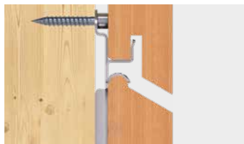
Raccord mural avec le clip pour façade en losange
