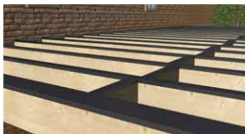
Exemple d'application Protectus, bande de protection du bois
