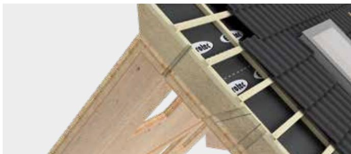
Topduo à tête cylindrique pour la fixation de matériaux d'isolation
