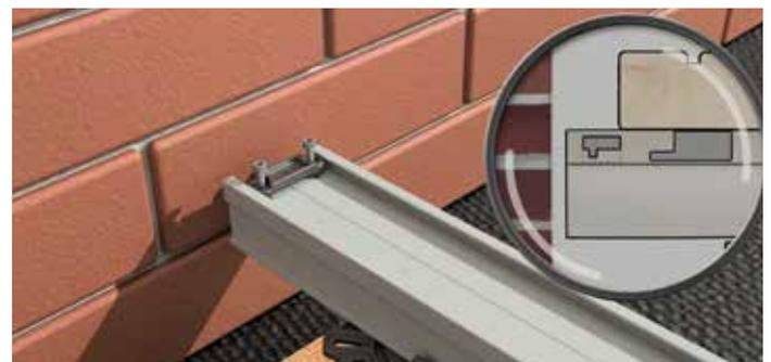
Fixation invisible d'une lame de départ/d'extrémité avec le StarterClip
