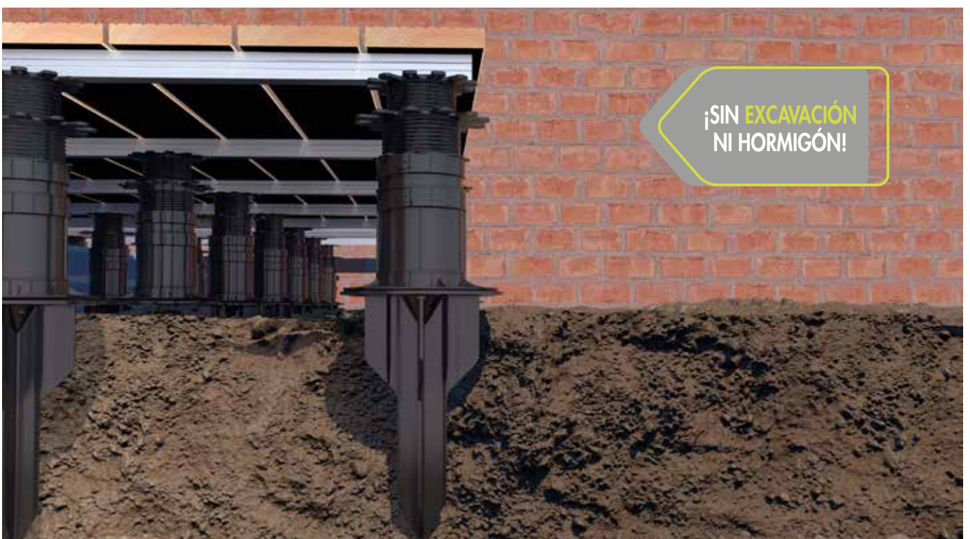
Anclaje para tierra FLEXI como fundación para la subestructura de una terraza.
