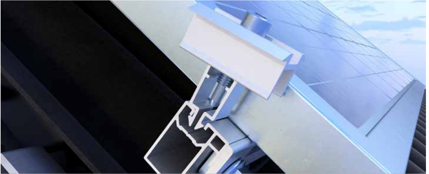
SCHRITT 2: Beim schrägen Einsetzen wird eine Seite der Klemme direkt arretiert.
