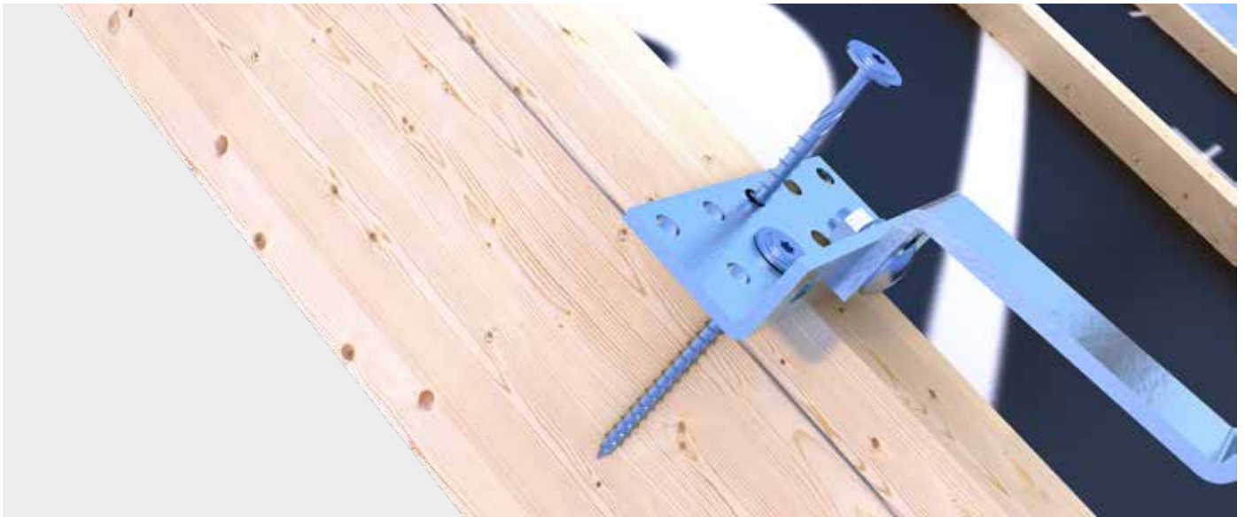
Die Paneltwistec Tellerkopfschraube wird zur Befestigung der Dachhaken genutzt und durch die Konterlatte in den Sparren geschraubt.
