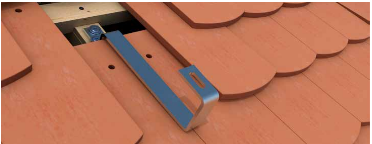
Dachhaken Biberschwanz an der Konterlatte montiert und mit Biberschwanzziegel eingedeckt.
