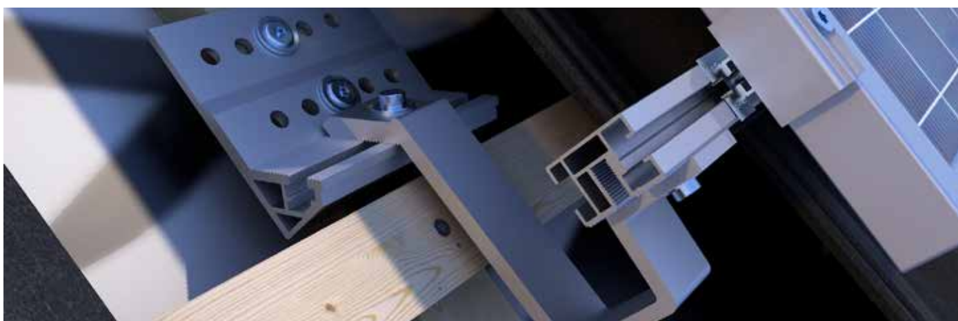
Dachhaken FIX-FIT an der Konterlatte montiert, durch die ausgeklinkte Dachpfanne geführt und mit montiertem Montageprofil FIX-FIT.
