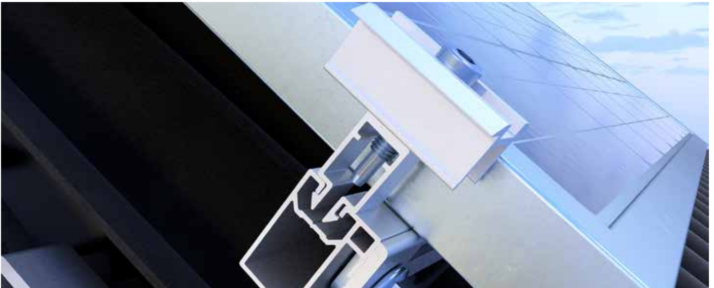
SCHRITT 3: Das gerade Aufstellen der Klemme lässt den zweiten Haken in das Profil einklicken.
