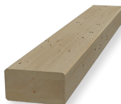
Bohlen d > 40 \text{ mm}, b > 3d Bretter d \leq 40 \text{ mm}, b \geq 80 \text{ mm}
