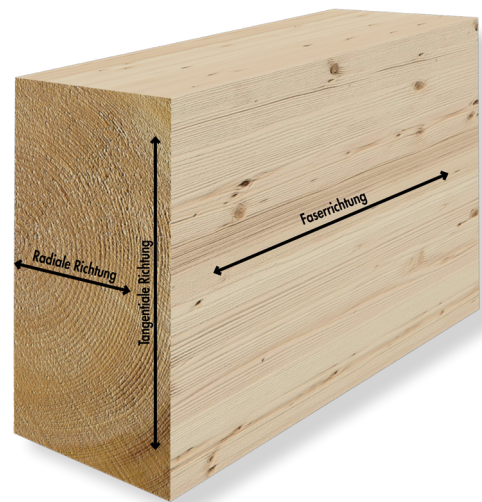
Schnittrichtungen des Holzes
