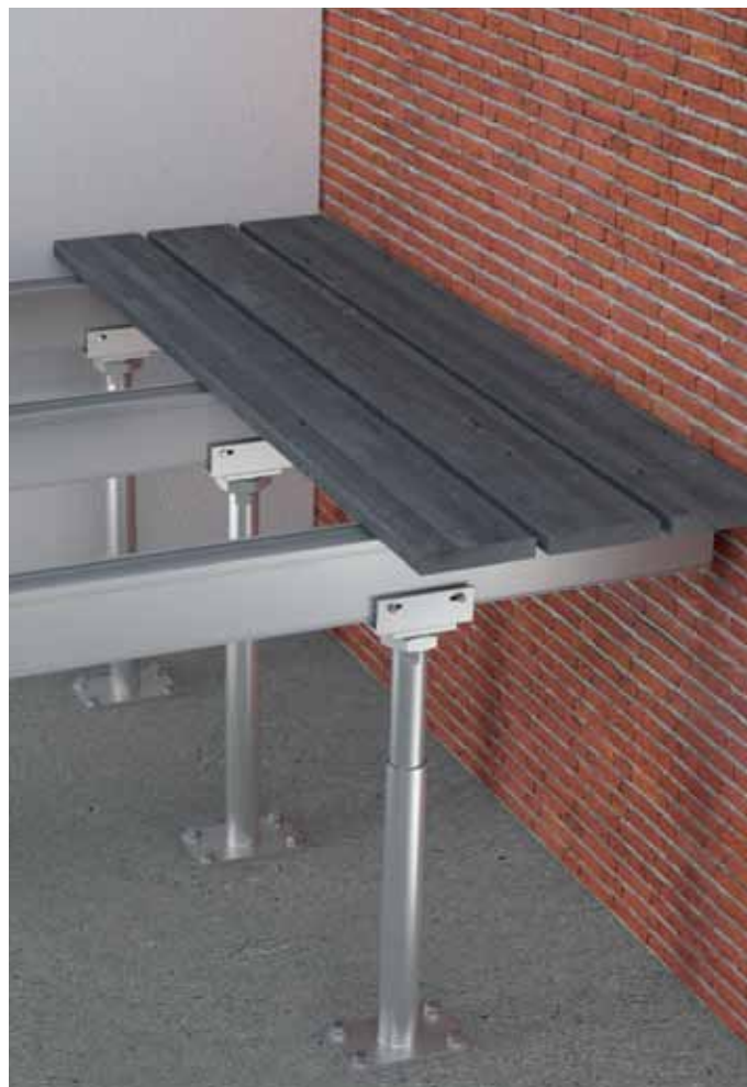
Le pied d'assise pour terrasse en combinaison avec le profilé porteur pour terrasse HKP
