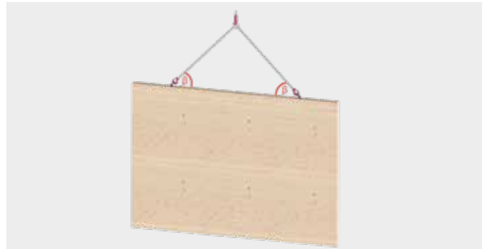
Mur ou poutre en bois lamellé croisé en position dressée
