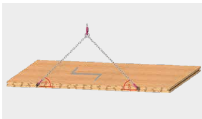
Ściana lub dźwigar BSH leżący, układ włókien: poziomy
