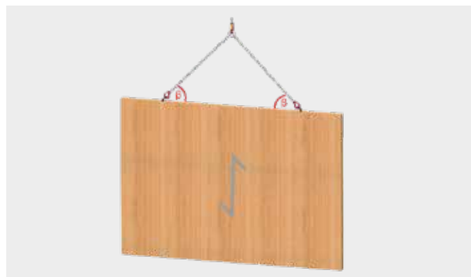
Ściana lub dźwigar BSH stojący, układ włókien: pionowy
