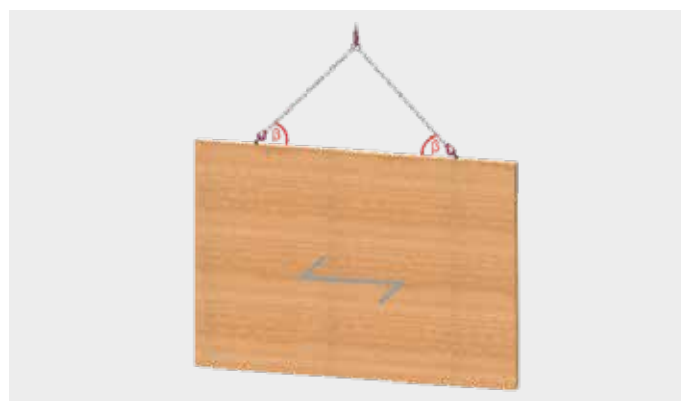
Ściana lub dźwigar BSH stojący, układ włókien: poziomy
