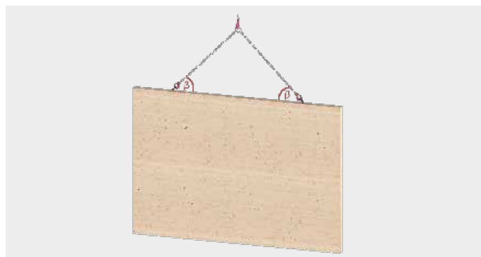
Ściana lub dźwigar stojący CLT
