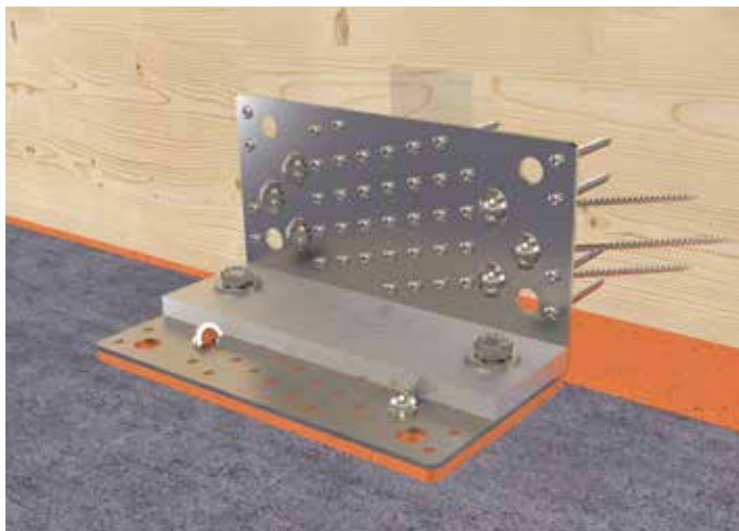
Scherwinkel zur Befestigung einer Wand am Betonfundament.
