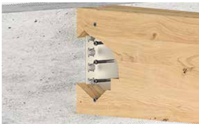
Anwendung Kombination EST Stabdübel und T-Profil
